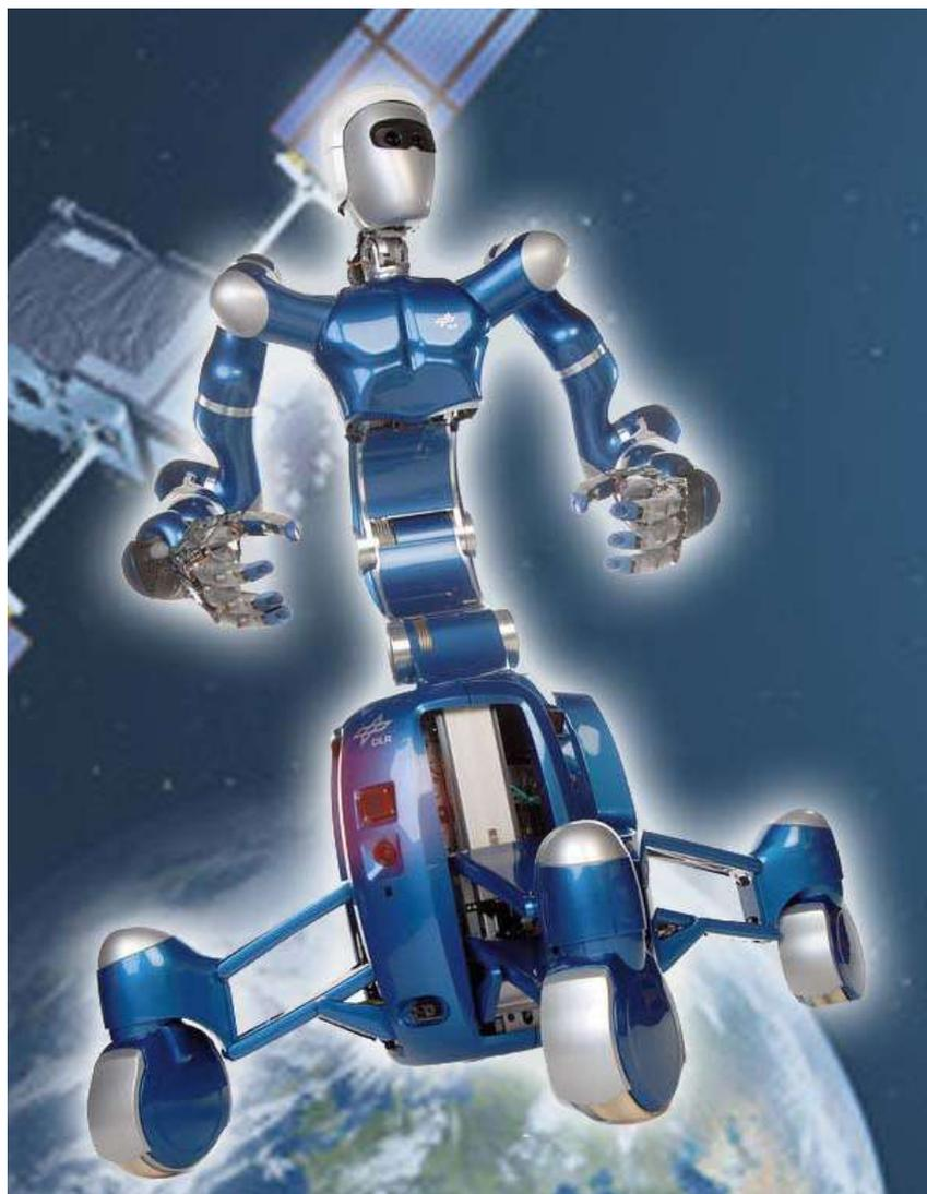
astronautas de la Estación Espacial controlarán a distancia el prototipo del rover Eurobot de la ESA desde un ordenador equipado con un joystick y unos monitores especiales. Este prototipo es un rover de cuatro ruedas y dos brazos, que cuenta con un avanzado sistema de navegación, cámaras y sensores, que se está probando desde el año 2008 en el Centro Europeo de Investigación y Tecnología Espacial (ESTEC)
