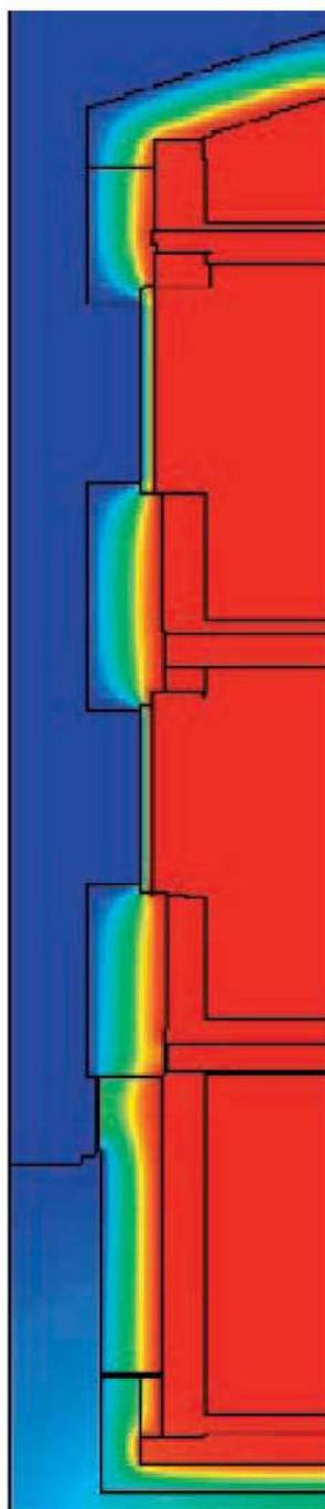
**Fig. 5:** Flujos isotérmicos en la construcción con sistema de aislamiento térmico por el exterior (SATE) y sótano climatizado.
