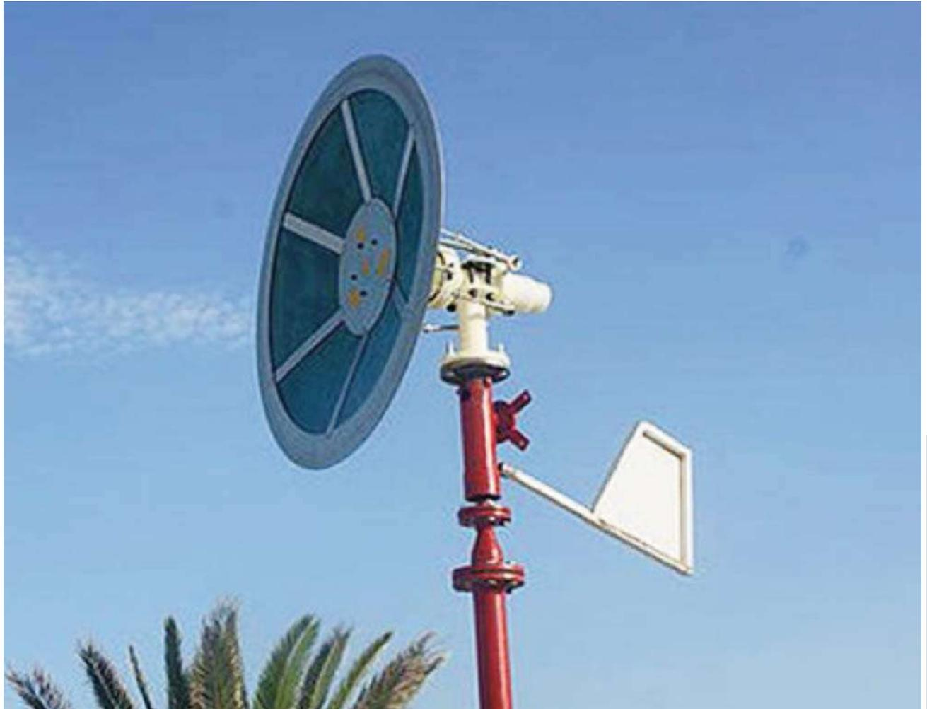
La Energía Safón ha creado un nuevo modelo que se aprovecha de la planta de energía eólica un 80% más energía que el viento convencional basado en turbinas. El Saphonian, como fue bautizada, está inspirada en las velas de los barcos para cosechar la energía cinética del viento, y por medio de pistones hidráulicos y la convierten en energía eléctrica.
