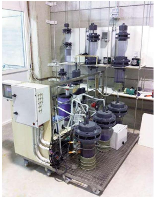
**Planta piloto de desulfuración para obtener hidrógeno a partir de biogás**
