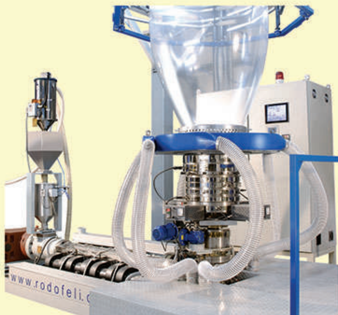
Extrusora de 90mm para 220cm de bobinado.
