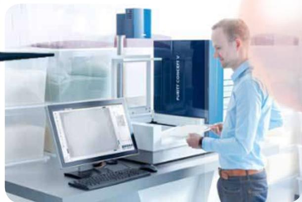
3: El PURITY CONCEPT V se utiliza para la prueba de muestras ópticas de granulado de plástico. Detecta entre otras, partículas negras.
