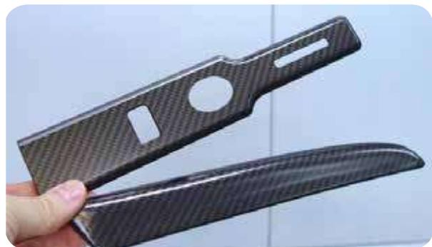
Fig. 6: Ejemplos del programa de prueba actual en LEONHARD KURZ para ampliar las dimensiones del termoformado y los potenciales para formar esquinas y radios con varias láminas
