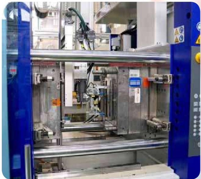
Fig. 4: Ambas máquinas de moldeo por inyección están equipadas con unidades de alimentación de lámina rollo a rollo. Los robots llevan un panel de calentamiento de lámina y en el lado opuesto una pinza de succión para retirar las piezas terminadas.
