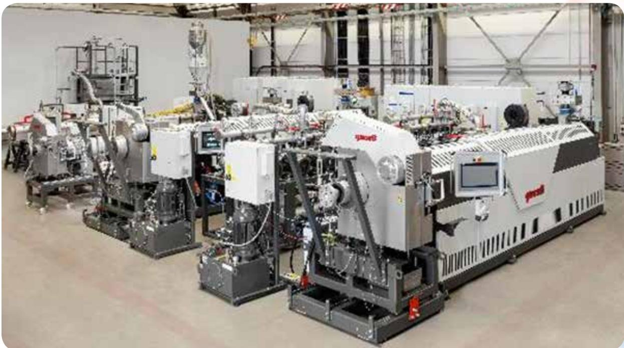
Fig.2: Varias unidades de procesamiento de Gneuss, incluidas las extrusoras MRS que se ensamblan en Gneuss
