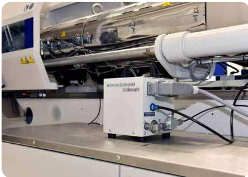
Fig. 3a: módulo CELLMOULD® en una MacroPower 1100
