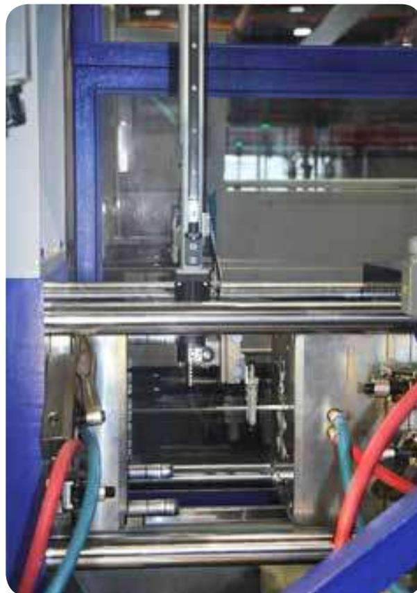
Fig. 3: Extracción de piezas con el robot W808 de WITTMANN
