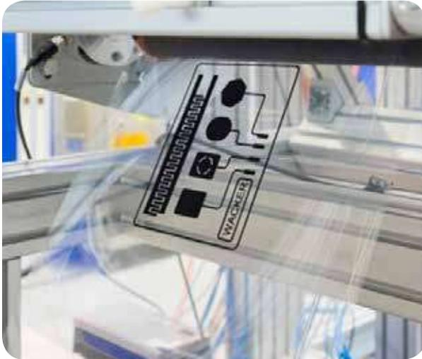
En la Feria K 2019 de Plásticos y Caucho, WACKER presentará NEXIPAL® por primera vez. NEXIPAL® consiste en laminados de silicóna electroactivos. Pueden generar vibraciones y señales hápticas en pantallas que pueden reconocerse sin contacto visual, solo con el tacto. (Foto: WACKER)
