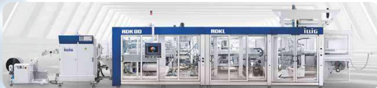
2: El nuevo sistema de termoformado ILLIG IC-RDKL 80 para la producción de tapas IML-T® decoradas. Imagen ILLIG.
