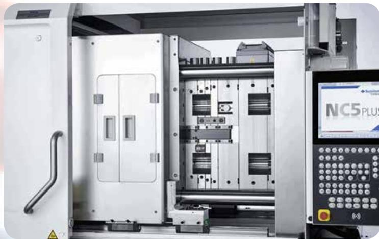
*4: El diseño compatible con GMP del área del molde IntElect S protege contra las partículas de polvo y garantiza una producción libre de contaminación para moldeadores médicos Imagen*
