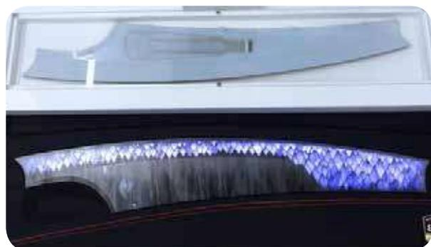
Fig. 7: Aplicación de la tecnología IMD en el lado visible del panel de la puerta de un automóvil. Además, un componente de lámina prefabricada de PolyIC, una empresa miembro de KURZ Group, se coloca en la parte trasera de la pieza moldeada, equipada con una estructura de sensor impresa para integrar el interruptor de luz interactivo y la función de atenuación.
