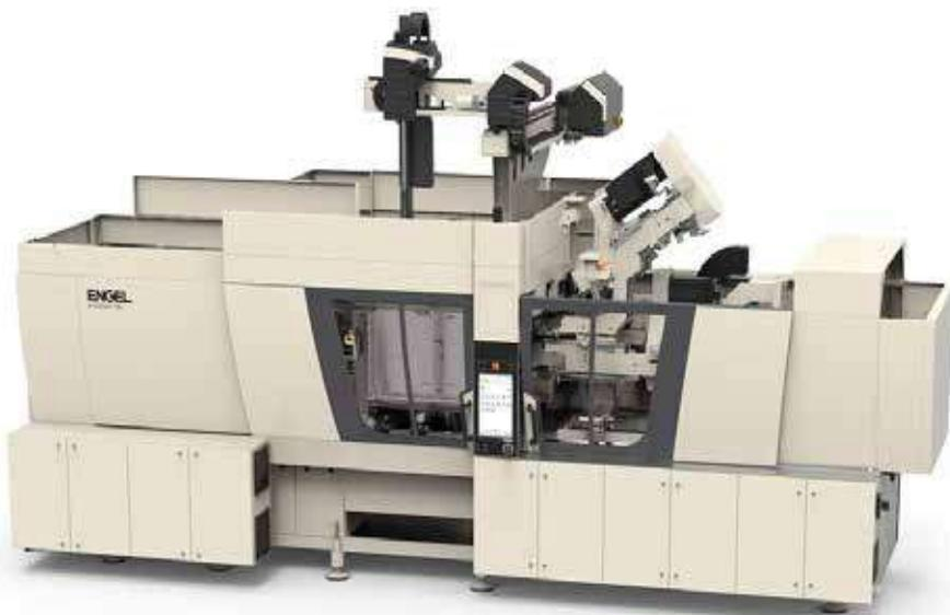
*La máquina de moldeo por inyección para salas limpias totalmente eléctrica e-motion 310H/170W/160 combi que se podrá ver en el stand de ENGEL estará equipada con un molde de 8 cavidades con tecnología Vario Spinstack de Hack Formenbau. (Imagen: ENGEL)*
