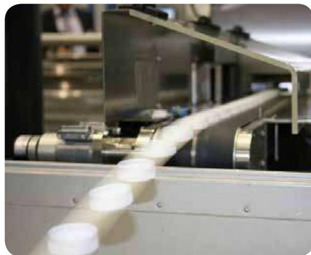
1: En una demostración en vivo en K-2019, Sumitomo (SHI) Demag producirá el equivalente a 130,000 tapas de botellas de agua por hora en un molde de 72 cavidades en un SP El-Exis
