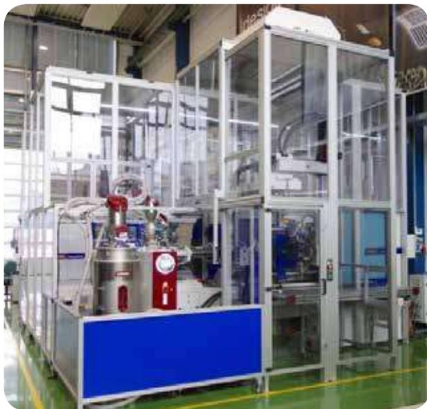
Fig. 3: KURZ ha aumentado su capacidad de aplicación/tecnología mediante la adquisición de dos celdas de producción "todo en uno" basadas en máquinas de moldeo por inyección SmartPower con una fuerza de sujeción de 2.100 y 1.200 kN.
