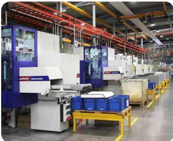
*Fig. 1: Máquinas de WITTMANN BATTENFELD: en primer plano la SmartPower 35, más reciente, con celda interna e integración con WITTMANN 4.0*
