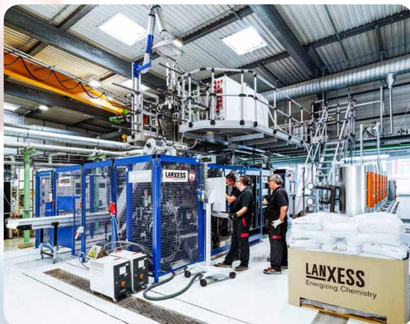
• Nueva máquina es una máquina de extrusión-soplado KBS20-SB de Kautex Maschinenbau GmbH, sede en Bonn. Foto: LANXESS AG
