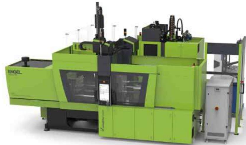
• En la K, ENGEL combinará una victory 120 AMM con una máquina de moldeo por inyección vertical ENGEL insert 60V/45 equipada con una placa giratoria de dos estaciones para fabricar piezas de recipientes de demostración bicomponente. Imágenes : ENGEL
