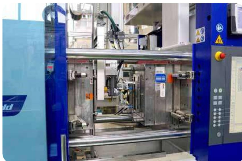
Fig. 4: Ambas máquinas de moldeo por inyección están equipadas con unidades de alimentación de lámina rollo a rollo. Los robots llevan un panel de calentamiento de lámina y en el lado opuesto una pinza de succión para retirar las piezas terminadas.
