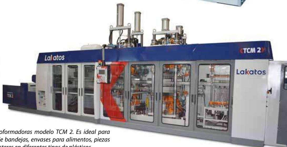
Lakatos Termoformadoras modelo TCM 2. Es ideal para la fabricación de bandejas, envases para alimentos, piezas perforadas y blísteres en diferentes tipos de plásticos
