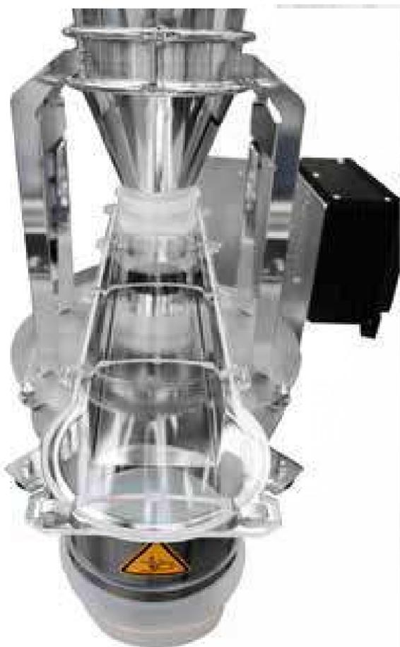
• El movimiento preciso y paralelo asegura un flujo uniforme del producto a lo largo de toda la longitud de la nueva bandeja del alimentador vibratorio K3 de K-Tron.
