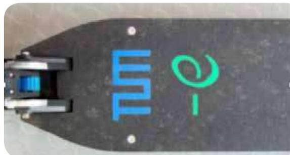
e-scooter con un escalón hecho de un material compuesto que integra granito y fibras de carbono de algas. Imagen: A. Battenberg / TUM
