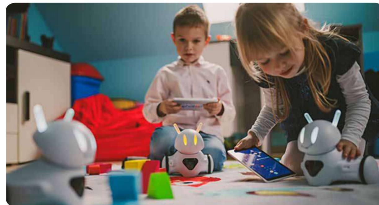
El robot educativo interactivo Photon presenta sensores, ojos y perfiles de rodadura fabricados con compuestos THERMOLAST® K de KRAIBURG TPE. (Fotos: © 2019 Photon Entertainment Sp. z o. o.)
