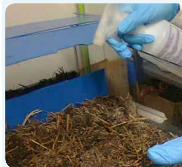
Ensayan una tecnología capaz de degradar agroquímicos utilizando el propio suelo y materiales de desecho. Permite tratar altas concentraciones, por lo que los investigadores apuntan a su uso en las operaciones de carga de pulverizadores.
