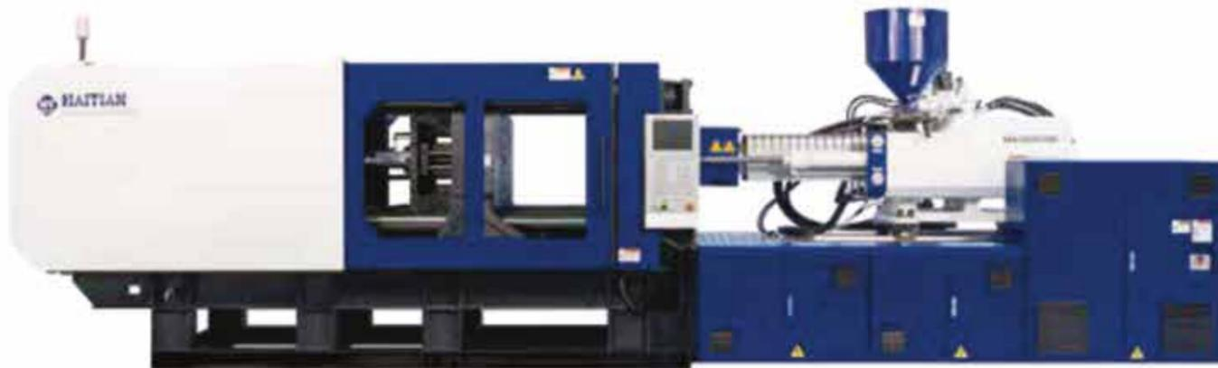
MARS/F es la nueva serie de máquina Haitian de alta velocidad, de 270 a 550 Tn de fuerza de cierre, con nuevos diseños en las unidades de cierre e inyección y de bajo consumo de energía.
