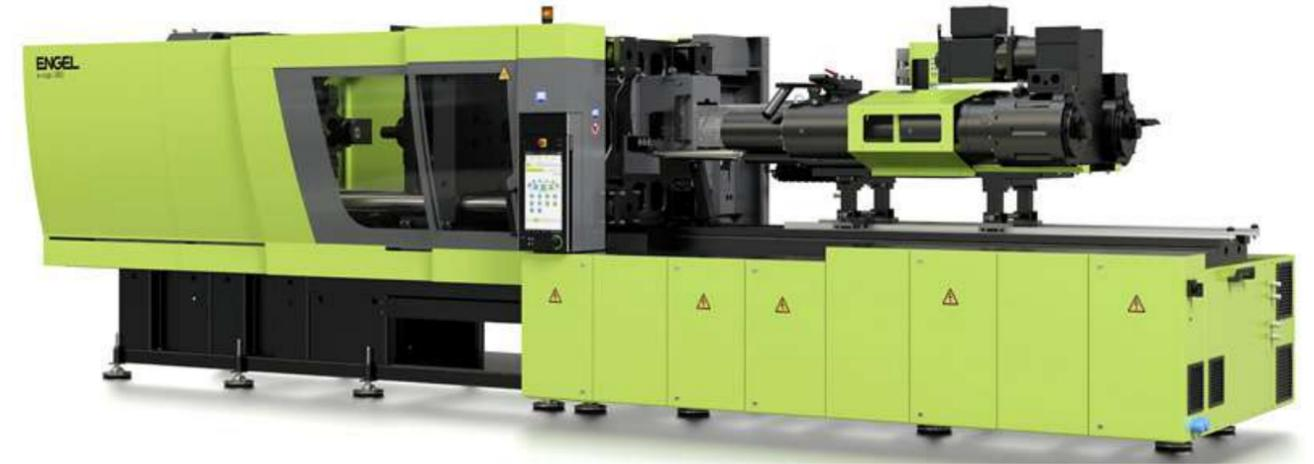
• La ENGEL e-cap es la única máquina de tapas en el mercado que ofrece un funcionamiento totalmente eléctrico en el rango de alta fuerza de sujeción.
