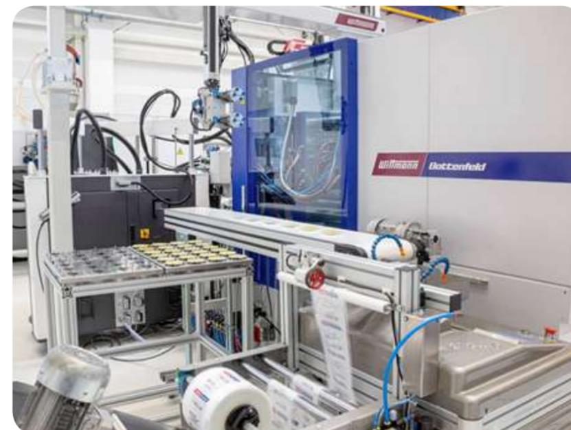
• SmartPower 120/350 LSR - estación de depósito y embalaje de piezas
