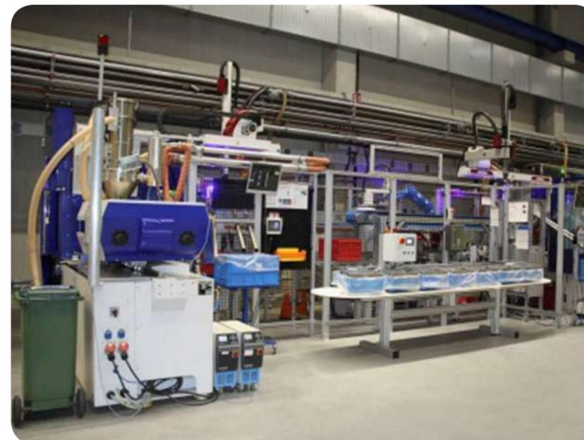
• Vista general de las máquinas de moldeo por inyección EcoPower 110/350 de WITTMANN BATTENFELD conectadas entre sí por sistemas de transporte con capacidad de acumulación.
