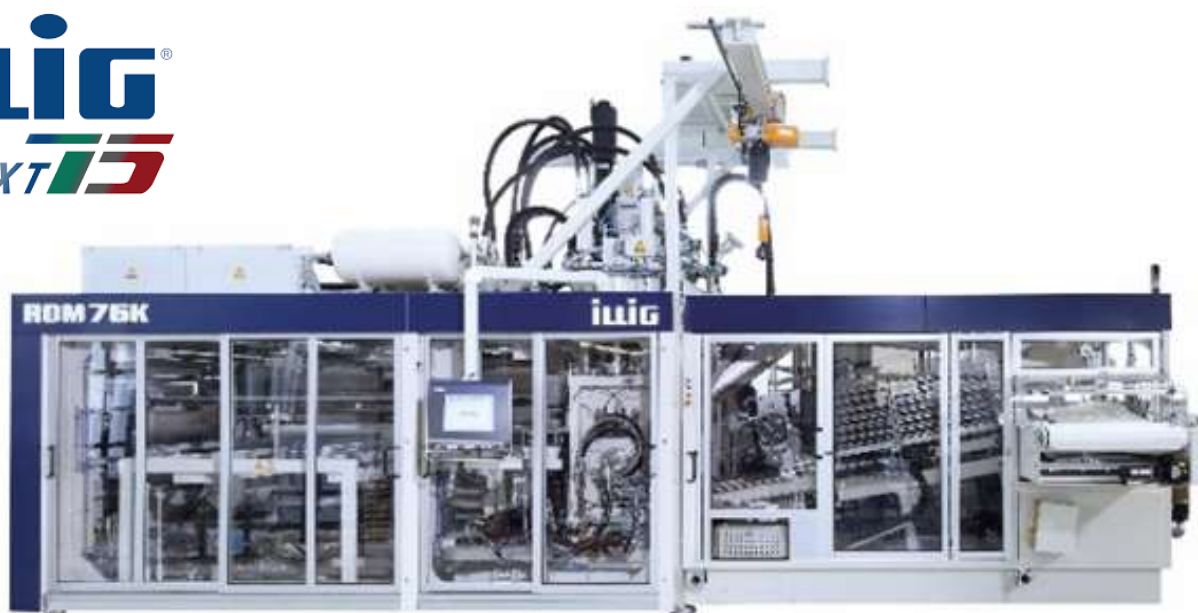
Fig. 2: ILLIG aumenta la fuerza de sujeción en un 50% hasta 900 kN con el RDM 76Kb. Ahora son posibles alturas de piezas moldeadas de hasta 255 mm.
