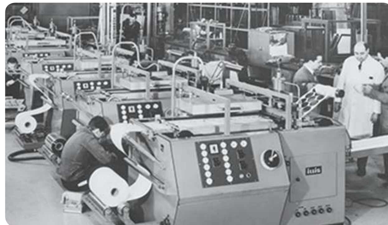
Imágen 3: En 1963, ILLIG desarrolla las primeras máquinas automáticas de moldeo de alta velocidad neumáticas para la operación de moldeo/perforación del tipo RDM 37/6 y lanza así la exitosa serie RDM.
