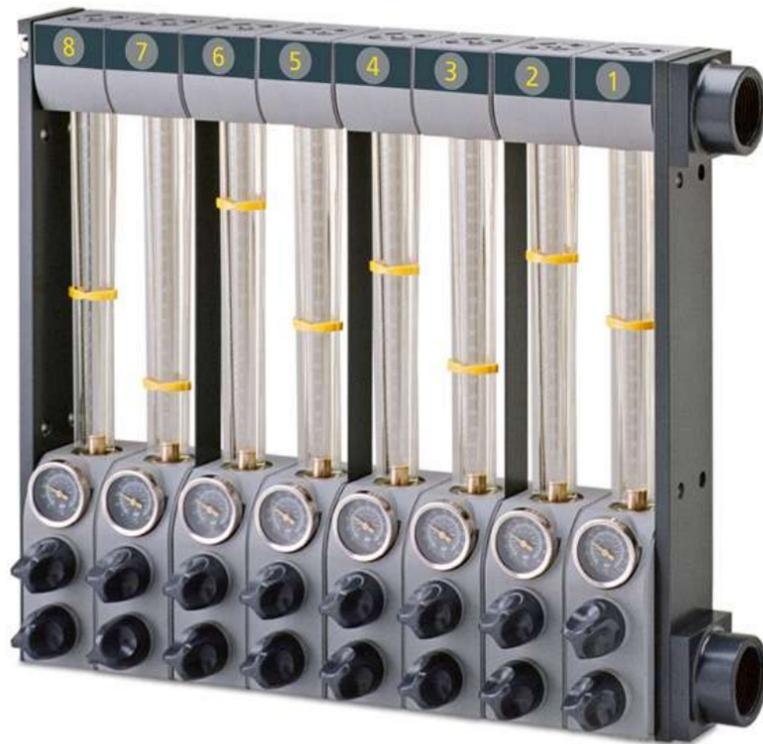
El dispositivo esencial para sus máquinas de procesamiento de plásticos para circuitos de refrigeración abiertos y cerrados. El volumen de flujo se indica de acuerdo con el principio de medición del flotador: un cono es levantado por el agua que fluye en el retorno del circuito del molde.
