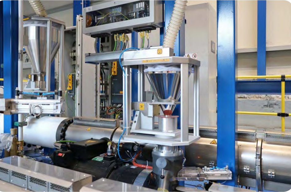
La unidad de cierre completamente eléctrica permite generar rápidamente la fuerza de cierre precisa e incrementar de manera notable la velocidad de avance
