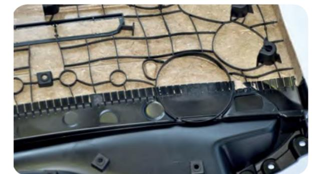
• Panel interior fabricado con una estera de fibra natural y reciclados, producido en una MacroPower 1100 con un molde suministrado por FRIMO (foto: FRIMO)
