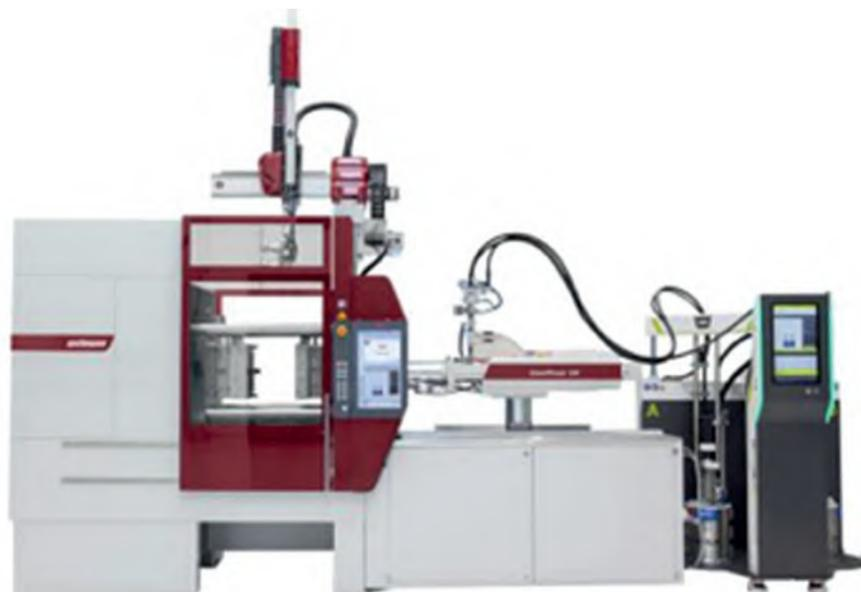
Este concepto no solo permite mantener bajos los costos de energía mediante el uso directo de electricidad solar, sino que la corriente continua también es fácil de almacenar en baterías convencionales, lo que brinda una excelente manera de manejar los picos de corriente. Si es necesario, la máquina se puede cambiar a funcionamiento con CA.
