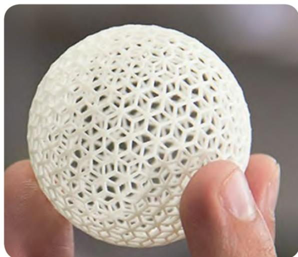
su fabricación. Por ejemplo, al diseñar un modelo 3D para extrusión se requerirán soportes y la complejidad de la pieza se verá limitada. Por otro lado, en los procesos de lecho de polvo, los modelos tienen mucha mayor libertad de diseño al no requerir soportes y poder reproducir hasta los detalles más pequeños. Así lo señala Jaume Altesa:
