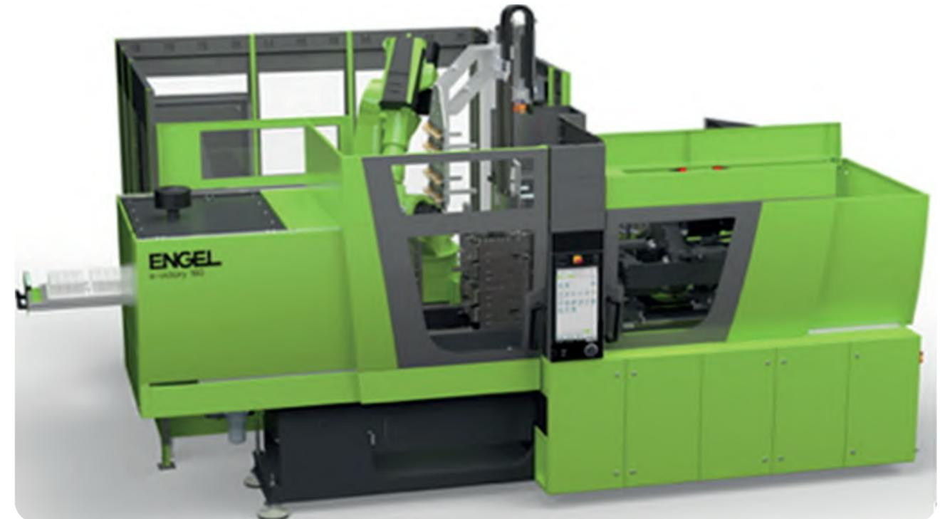
• El elevado número de cavidades combinado con la máxima precisión y una automatización compacta permiten alcanzar un nuevo nivel de eficiencia en la producción en serie de válvulas de pantalla LSR.
