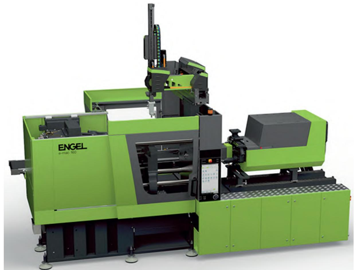
• Equipada con asistencia inteligente, la máquina de moldeo por inyección totalmente eléctrica e-mac compensa automáticamente las variaciones en la materia prima y garantiza la alta calidad constante de las piezas.
