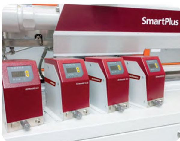
Fig. 3: Módulos Airmould 4.0, pequeños y directamente en la máquina de moldeo por inyección
