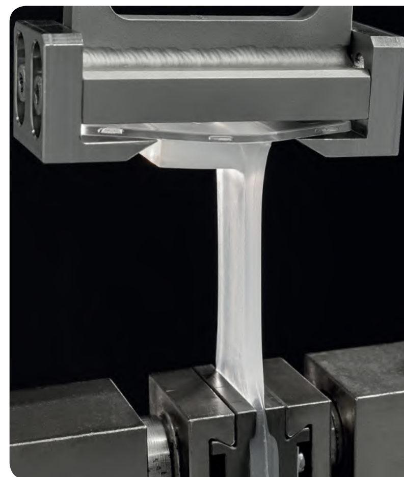
► Las pruebas de adherencia muestran que el nuevo caucho de silicona autoadhesivo ELASTOSIL de WACKER®LR 3078 se adhiere firmemente al policarbonato sin tratamiento previo. (foto: WACKER)
