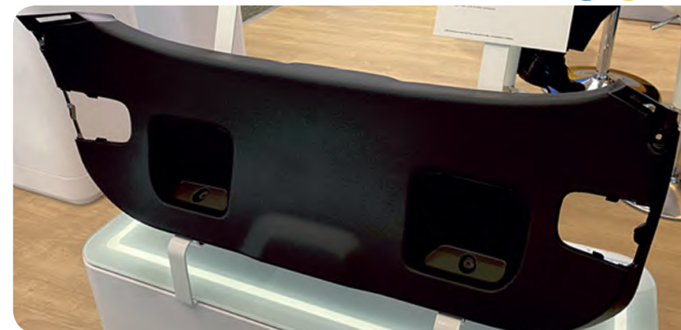
► Componente de moldura de portón interior acabado hecho con el grado PPc F9005 de SABIC® mediante moldeo por inyección espumado (FIM). La pieza moldeada incorpora fijaciones, nervaduras, alveolos, receptáculo, cúpulas, orificios, texturas y una estética excelente. El compuesto de PP de SABIC ofrece fluidez elevada, puede disminuir las marcas de hundimiento y reduce el peso en hasta un 20 por ciento.
