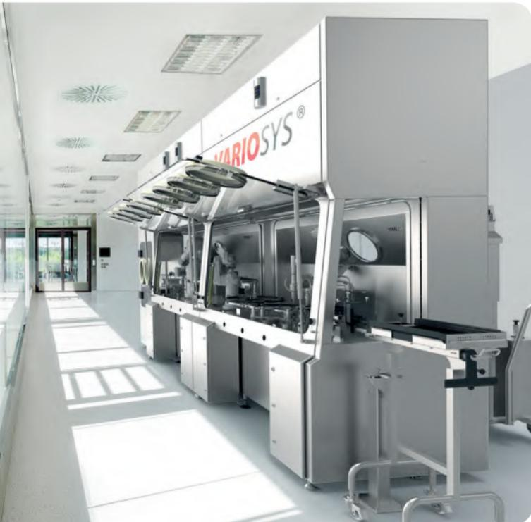
*Bausch+Ströbel apuesta por sistemas integrales que permiten un cambio rápido de módulos y ciclos reducidos de esterilización y ampliación. Foto: Bausch+Ströbel*
