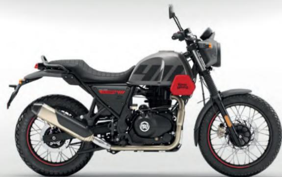
El freno trasero está compuesto por discos de 240 mm y pinza flotante con monopistón. Además, la SCRAM 411 posee llanta delantera de 19" con neumático de 100/90-19"; y trasera de 17" con 120/90-17". Los neumáticos mixtos permiten un buen equilibrio de comportamiento tanto en asfalto como fuera de él.
