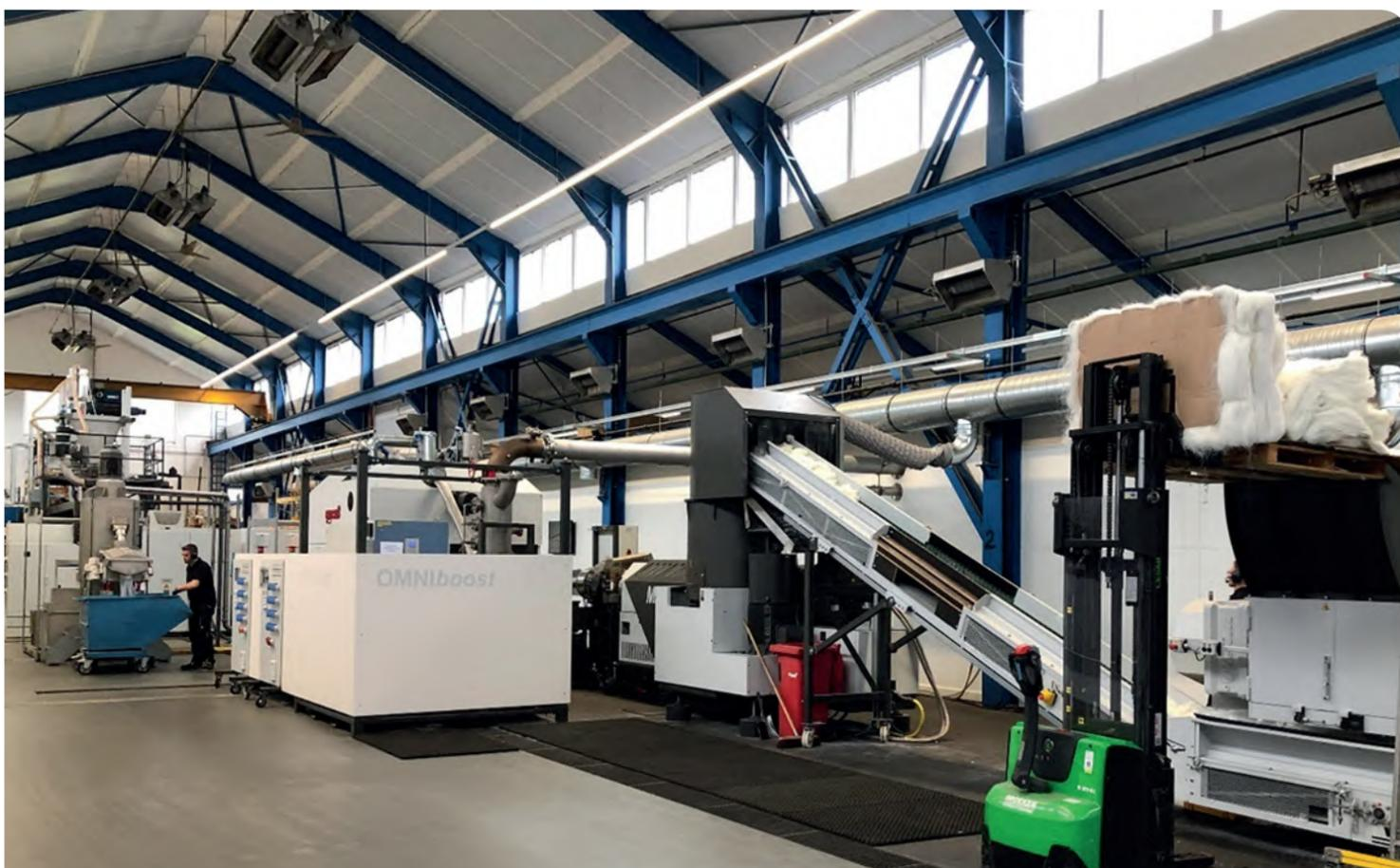
como fibras de desecho o películas delgadas. Sin necesidad de ningún tratamiento térmico previo, el material ingresa al alimentador rotativo Gneuss 3C, que corta y compacta el material, además de alimentarlo directamente al tornillo extrusor MRS. La extrusora Gneuss MRS se basa en la extrusora de un solo tornillo simple y resistente, sin embargo, está equipada con una sección de múltiples tornillos para una desgasificación optimizada.
