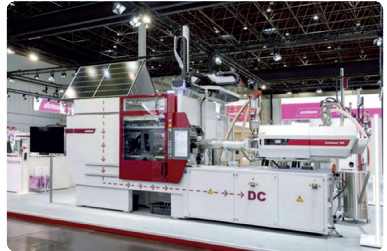
• EcoPower 180 DC - Estudio conceptual de una máquina de moldeo por inyección totalmente eléctrica que puede funcionar con corriente continua.
