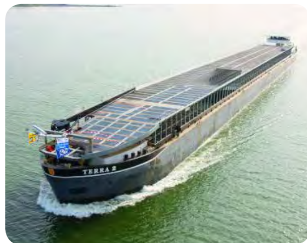
• Híbrido: Roro Terra 2. Año de construcción 2014 | Eslora 135 m | Manga 11,45 m | Calado 4,30 m | Tonelaje 1090 t | Motores 2 x Caterpillar tipo C18 | Híbrido Baumüller DST2-400, 2 x 285 kW
