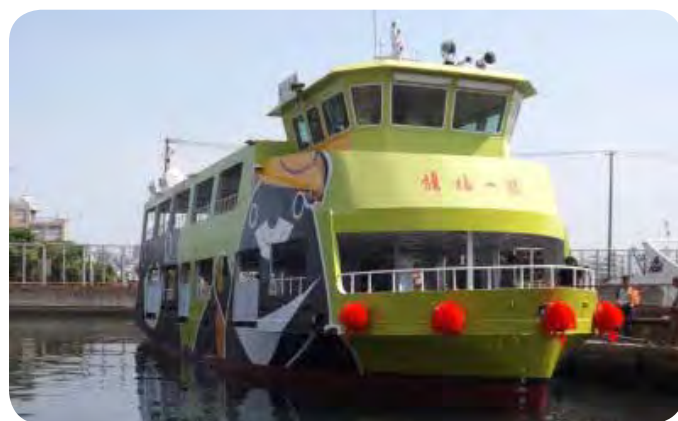
• Totalmente eléctrico: Qi-Fu No. Año de construcción 2017 | Eslora 25 m | Manga 6,5 m | Capacidad: hasta 150 personas; 46 bicicletas | Motores 2x 2 powerMELA®- cada sistema con 150 KW
