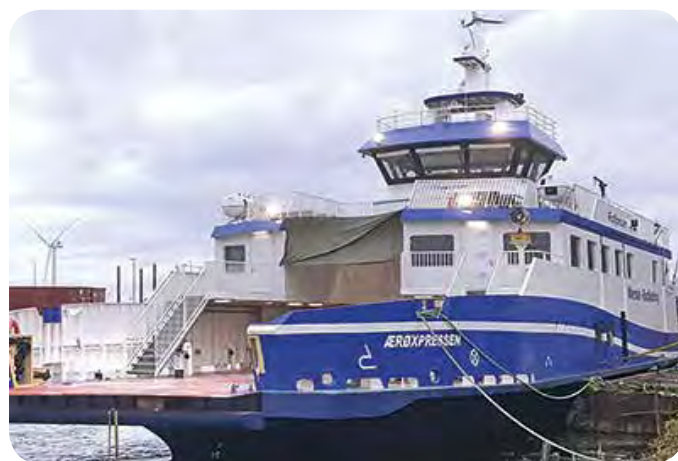
• Híbrido: AERØxpressen. Año de construcción 2019 | Eslora 49,36 m | Manga 12,50 m | Calado 1,92 m | 2 x motores diesel Scania DI16 de 8 cilindros, 2x motor de propulsión 450 kW
