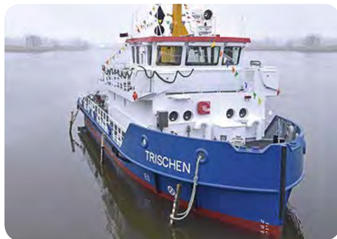
• Diésel + eléctrico: Trischen. Año de construcción 2019 | Eslora 22 m | Manga 7,5 m | Diésel + eléctrico | 2x motor de propulsión DST2 225 kW
