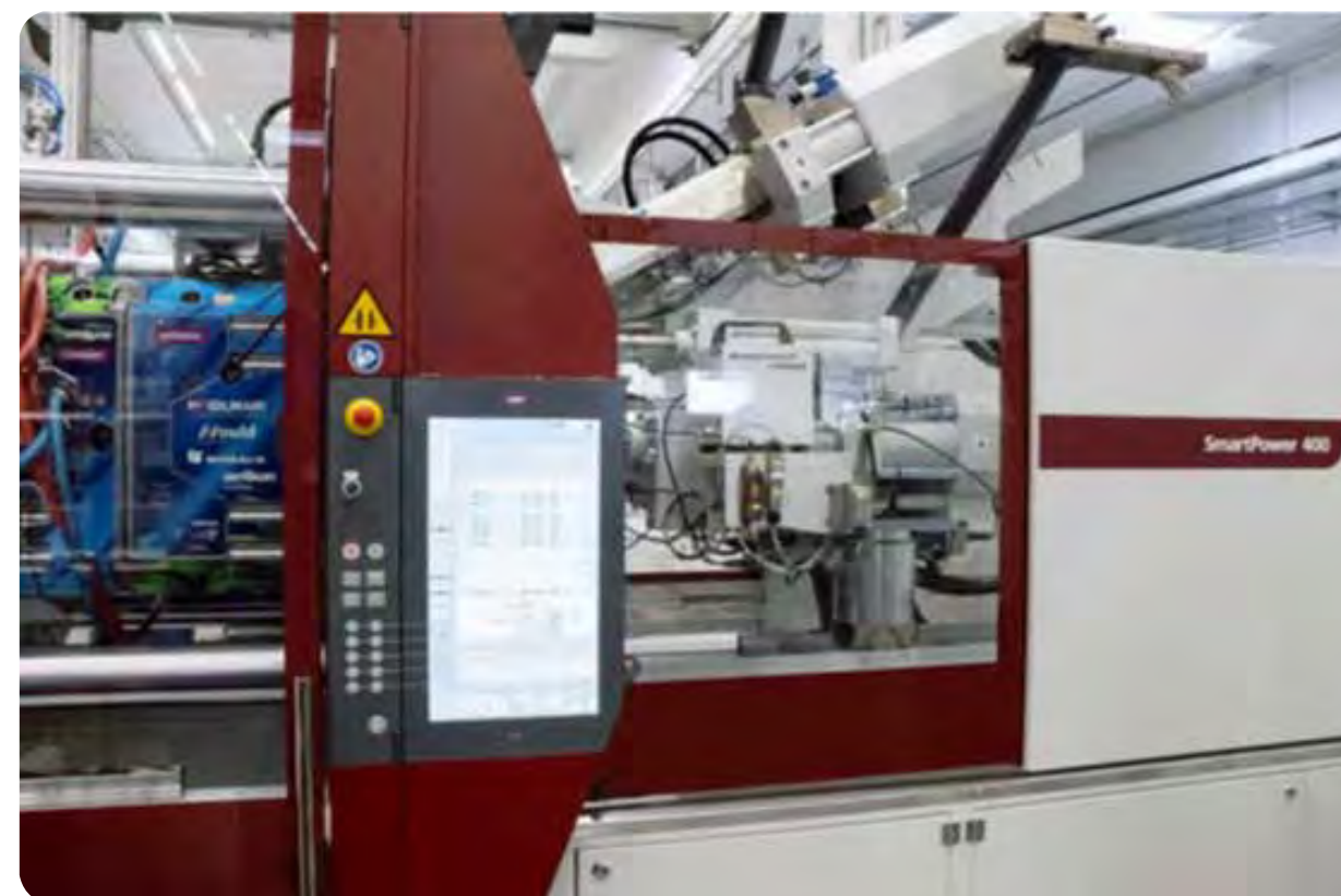
• Máquina de 3 componentes equipada con tecnología Cellmould.
