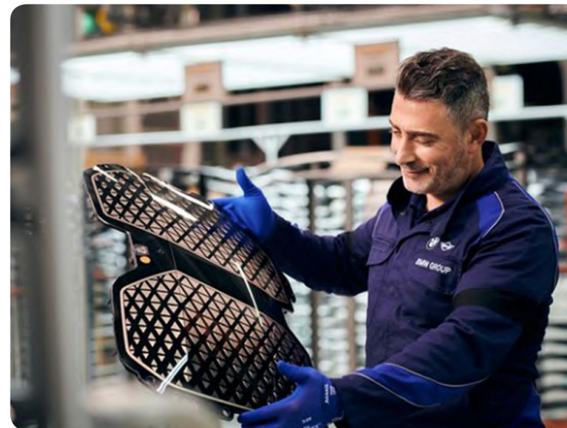
• Las insignias en forma de riñón para el nuevo BMW iX se fabrican en una célula de producción de sala blanca altamente integrada de ENGEL. Se trata de la primera aplicación de producción en serie de la combinación de retroinyección de película y recubrimiento por inmersión con poliuretano en el exigente exterior del vehículo. (Foto: BMW Group)
