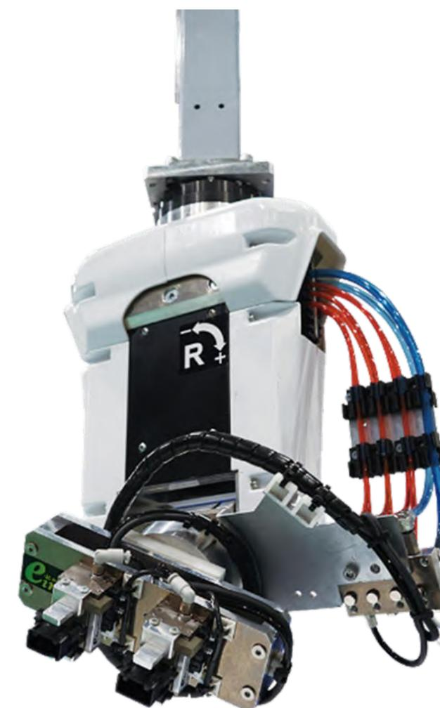
Ripress: robot XW-1500VI instalado en prensa IT HES 700 para aplicación pick-and-place de una caja desde un molde de una cavidad de Mobil Plastic.
