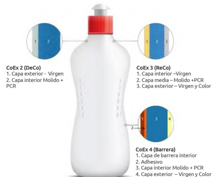
**Reducción del uso de plásticos vírgenes** con tecnología de coextrusión multicapa para el uso de material plástico post-consumo (PCR) en el proceso productivo de acuerdo con la normativa europea.
