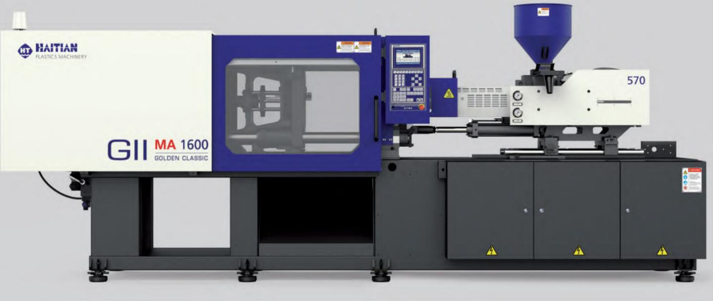
Nueva serie de máquinas **Haitian Mars/GII** de inyección de termoplásticos con servomotor, ghias lineales en la inyección y unidad de cierre con bujes autolubricados
