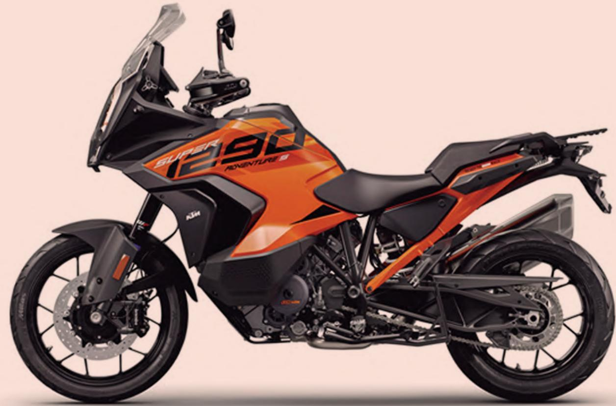
tes del conductor. A su vez, el motor logra cumplir con la normativa Euro5, con un sistema de alimentación de inyección electrónica KEIHIN con RBW (control de crucero y doble encendido), vinculado a una caja de cambios Pankl de seis velocidades, y mediante un sistema de embrague multidisco en baño de aceite antirrebote PASC. A su vez, tiene de serie 4 modos de conducción y tipos de control de tracción: Rain, Street, Sport y Off-Road, mientras que de forma
