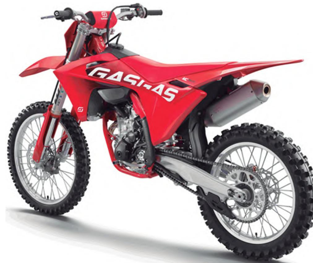
resistencia y diseñado en exclusiva para GASGAS, luce una diferente curvatura, junto con un protector distinto, más voluminoso, pero más seguro y puños ODI de compuesto medio con bloqueo. Los estribos son más grandes consiguiendo un mayor apoyo con las botas.
