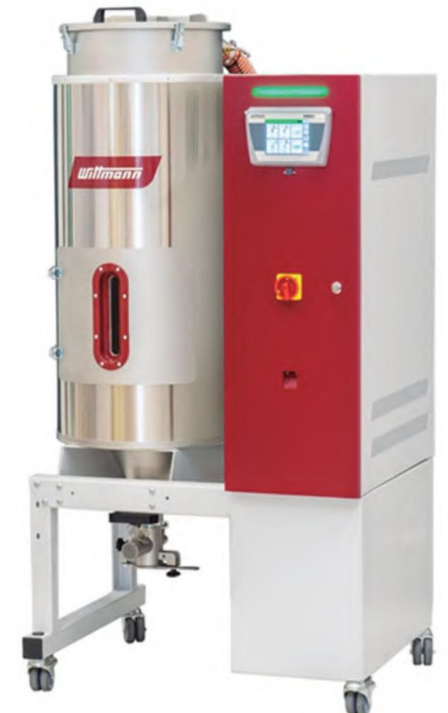
de serie también contribuye al ahorro de energía. Al mismo tiempo, evita el secado excesivo y, en consecuencia, el daño térmico del granulado de plástico. En cuanto se reduce o detiene el consumo de material, el sistema reduce automáticamente la temperatura de secado.
