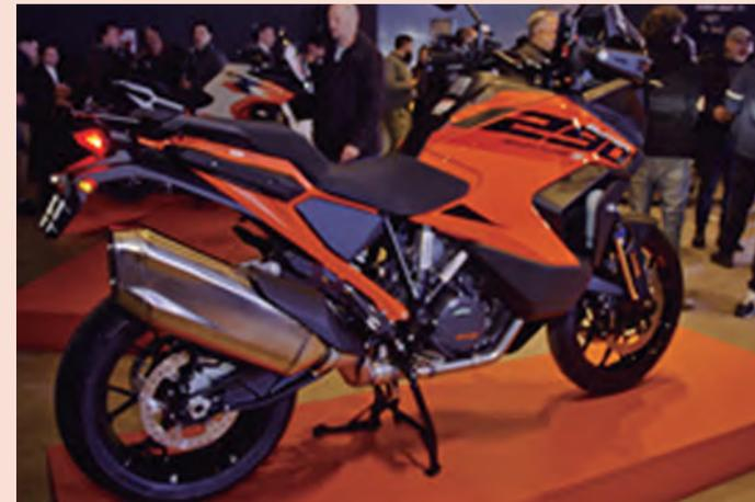
permite una mejor accesibilidad a pilotos de menor talla sin repercutir en la fiabilidad. El asiento, además, es ajustable en altura con 20 mm de diferencia entre la posición alta (869mm) y la baja (849mm).
