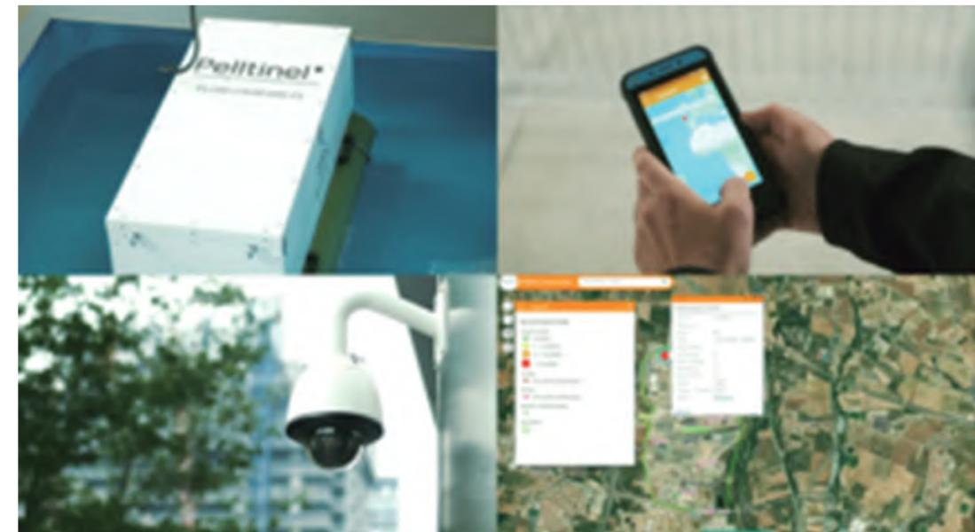
• Por eso desarrollaron Pelltinel, una tecnología basada en la visión artificial y la monitorización remota que permite detectar, cuantificar y monitorizar los pellets que se pueden derramar en diferentes puntos de cada instalación. "Así podemos saber si hay zonas en las que se producen fugas de manera recurrente y si es necesario buscar soluciones específicas para situaciones concretas como lluvias más fuertes de lo habitual".
