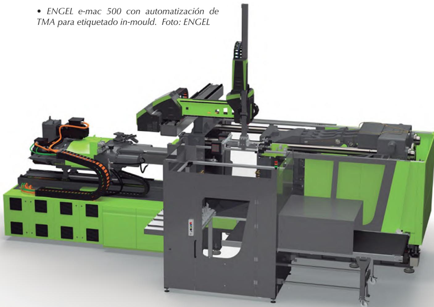
nedores de 4 litros con etiquetado in-mould en un molde de dos cavidades con un tiempo de ciclo de sólo 8 segundos. La automatización, que incluyó un robot lineal viper, también contó con componentes de la filial de ENGEL, TMA (Imagen 2).
