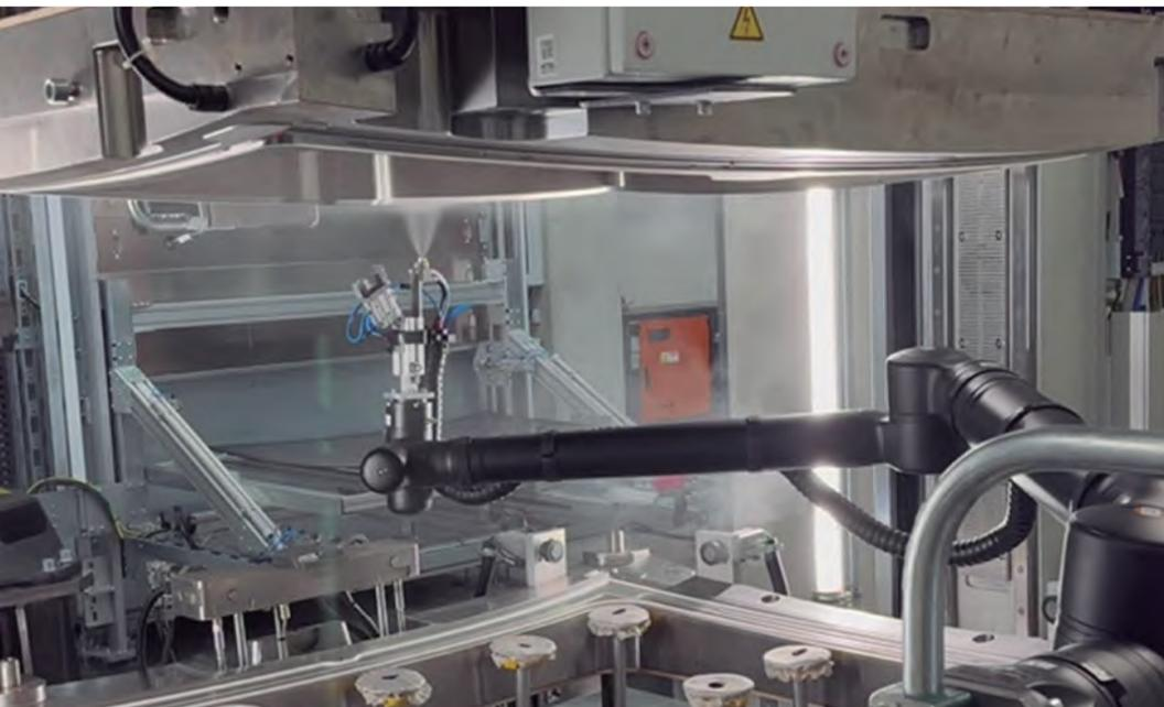
• Además de los sistemas de manipulación, existe una gran demanda de células de automatización equipadas con robots que, por ejemplo, aplican agentes desmoldeantes (en la imagen) a las superficies de los moldes
