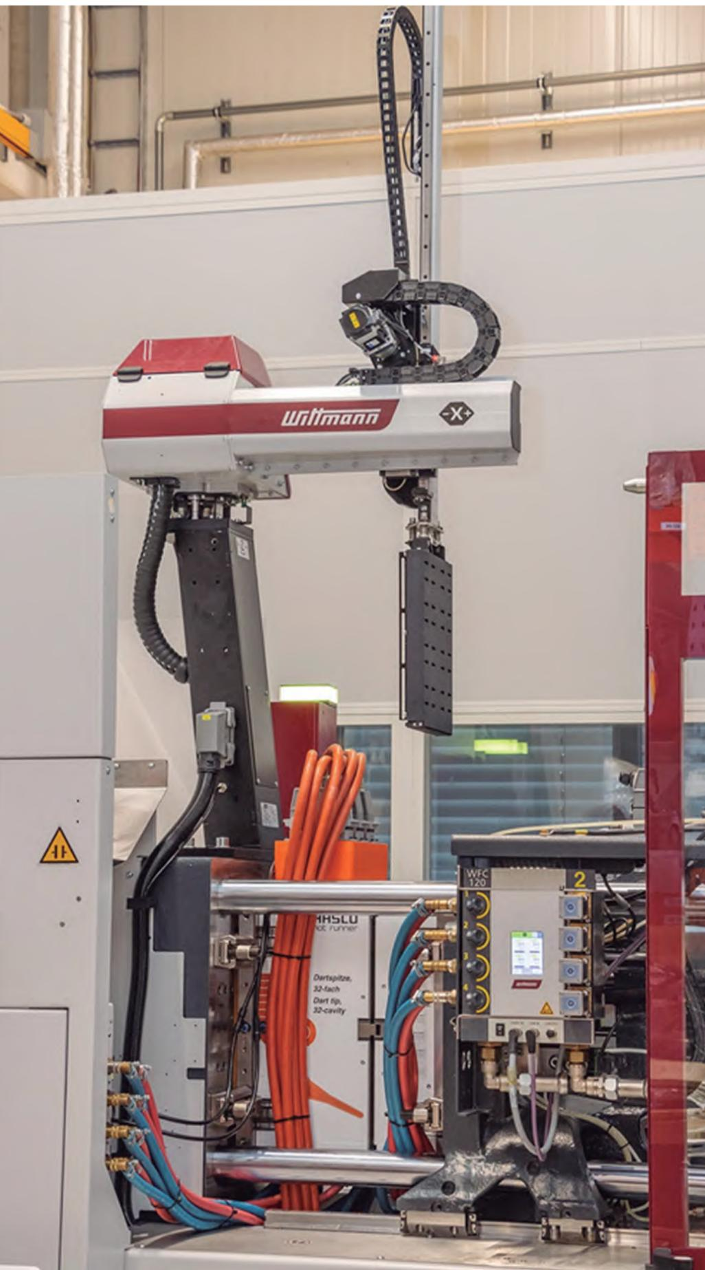
también se encarga de manipular piezas pequeñas en máquinas de moldeo por inyección con fuerzas de cierre de hasta 200 toneladas.
