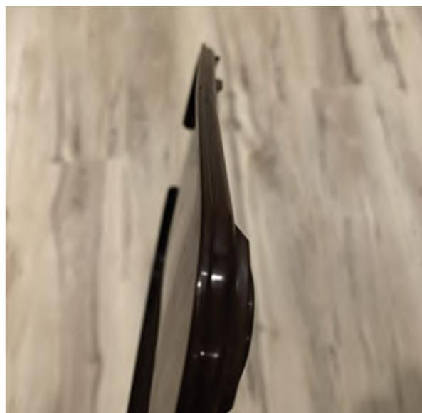
torsión, se produce cuando una pieza moldeada no ha adoptado la forma del molde. Bill lo compara con recibir una Pringle cuando esperabas un plato. Las causas de la deformación son complejas, pero lo más común es que se deba a un enfriamiento no uniforme, a la contracción o a la tensión.
