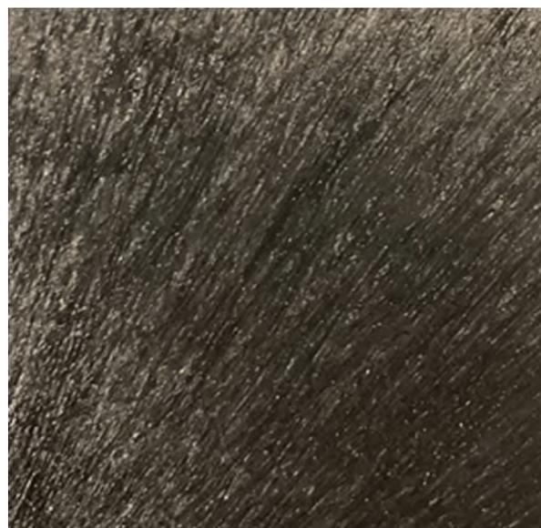
por humedad se produce por niveles excesivos de humedad en el material. La dispersión por humedad es visible en toda la pieza, lo que facilita su identificación, mientras que la dispersión por calor suele estar más localizada. La dispersión por calor se parece a la dispersión por humedad, pero se produce por un procesamiento excesivo. Cuando el polímero está demasiado caliente durante demasiado tiempo, se degrada y provoca la dispersión por calor.
