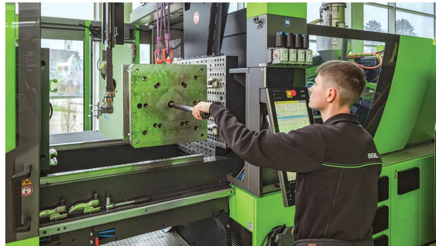
• Tiempos de cambio de herramienta más cortos, mayor eficiencia de producción y reducción de errores con el asistente de configuración de ENGEL. Imagen: ENGEL
