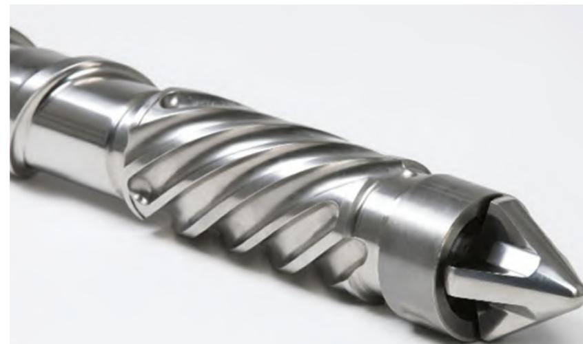
La boquilla de cierre de corredera giratoria de nuevo desarrollo de ENGEL para el sector del envasado optimiza el flujo de material con grandes secciones transversales, lo que reduce tanto el cizallamiento como el sobrecalentamiento. Su diseño innovador permite tiempos de conmutación muy cortos, lo que la hace especialmente valiosa para aplicaciones con tiempos de ciclo cortos.
