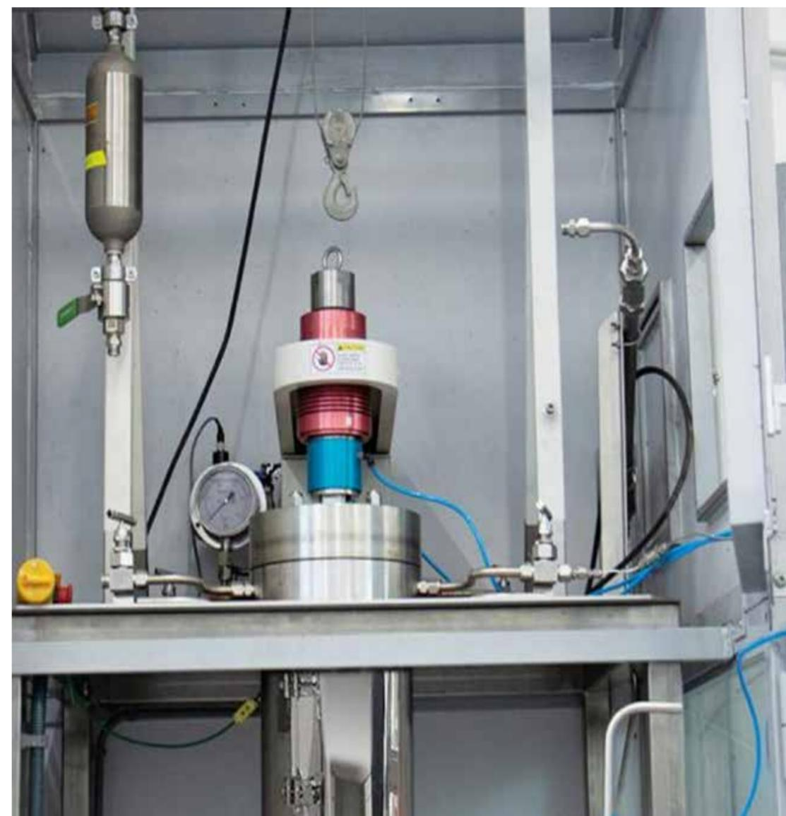
la posibilidad de emplear autoclaves de acero inoxidable del tipo AISI-316L. Este material tiene una gran compatibilidad química y resistencia a la corrosión. Contamos con reactores de este tipo de entre los 10 y los 100 L de capacidad. Estos reactores cuentan con agitadores mecánicos y calefacción eléctrica con la posibilidad de alcanzar temperaturas de hasta 300 °C.
