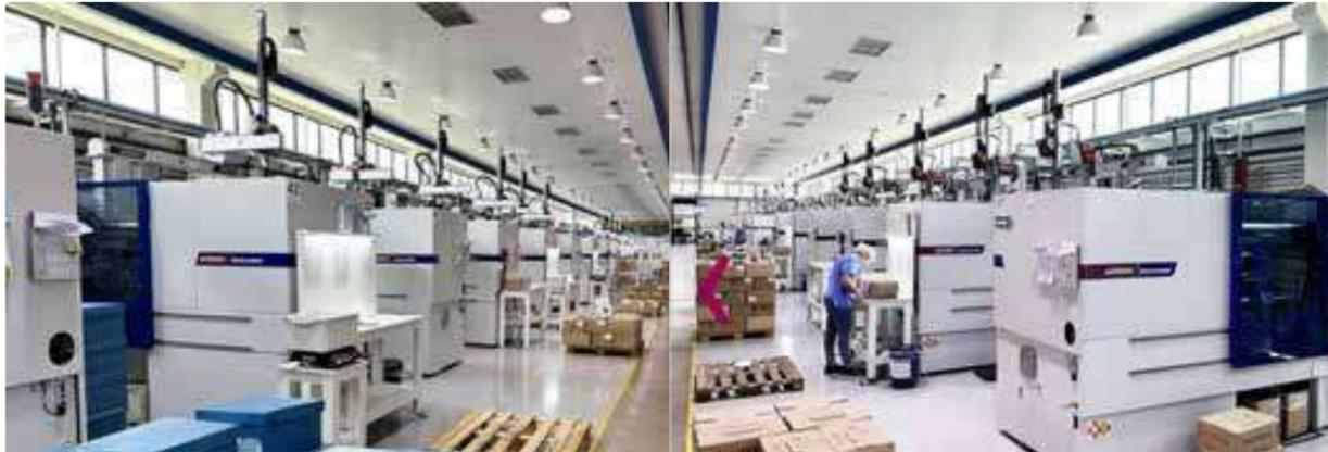
• Un total de 44 máquinas de moldeo por inyección están en funcionamiento. La mayor parte está ocupada por máquinas servohidráulicas SmartPower de WITTMANN, cada una equipada con un robot lineal de WITTMANN. (Fotos: WITTMANN)
