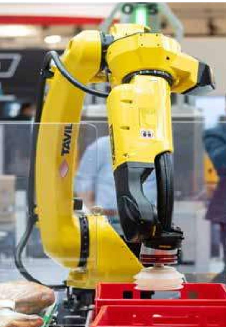
máquinas especializadas convencionales y las que integran tecnología robótica es fluida. Los robots industriales se utilizan sobre todo para realizar tareas repetitivas que suelen ser típicas en el procesamiento de la carne, como cortar, dividir en porciones, empaquetar, envolver, clasificar, recoger o colocar.
