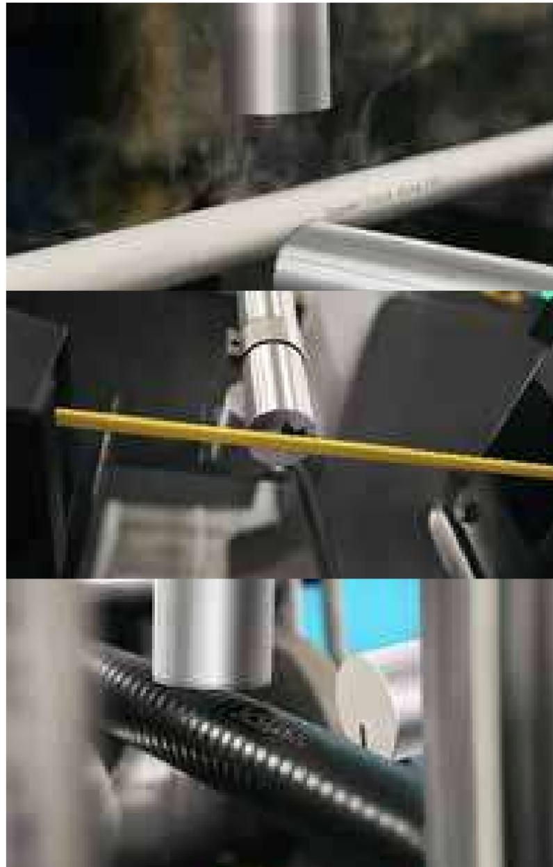
• *Encore Wire marca una amplia variedad de cables en su planta en Texas. El LEIBINGER JET RAPID puede marcar cables a velocidades de hasta 3.280 pies por minuto.*
