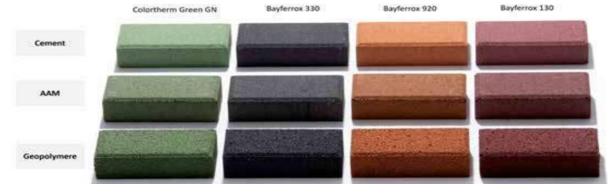
geopolímeros. El equivalente a base de cemento también se produjo en los experimentos como referencia. La producción se llevó a cabo según las especificaciones de la norma DIN EN 12878. Además, se utilizaron activadores y aditivos de Rhein-Chemotechnik GmbH en la producción de las muestras de geopolímeros y materiales activados con álcali.
