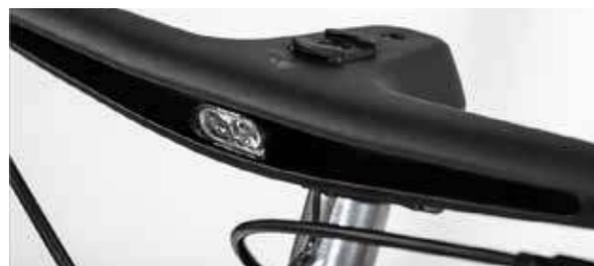
• *Resistente, ligero y funcional: el nuevo manillar de bicicleta para bicicletas CANYON. Fabricado con el sistema ENGEL, este manillar sustituye por completo una solución de aluminio, con un tiempo de ciclo muy corto, un peso aproximadamente un 15 % menor y una mejor amortiguación de las vibraciones.*
