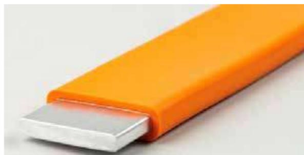
• Barra colectora aislada con ELASTOSIL® R 531/60 (naranja). El nuevo caucho de silicona se ceramiza en caso de incendio. Como resultado, los raíles permanecen aislados incluso en caso de accidente o incendio del vehículo. Esto proporciona protección adicional a los pasajeros de vehículos eléctricos y al personal de rescate. (Foto: WACKER)
