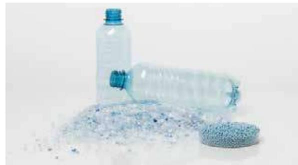
• El rPET producido con la tecnología recoSTAR PET art de Starlinger se puede utilizar hasta al 100% en la producción de envases en contacto con alimentos. © Starlinger
