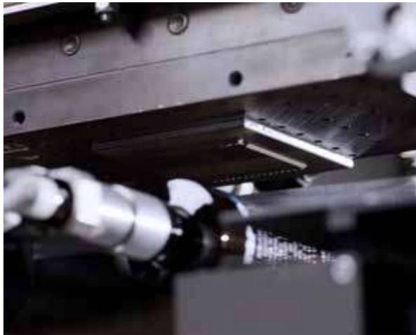
“La nueva unidad de estampado en caliente permite la aplicación de acabados metálicos directamente en la máquina”.
