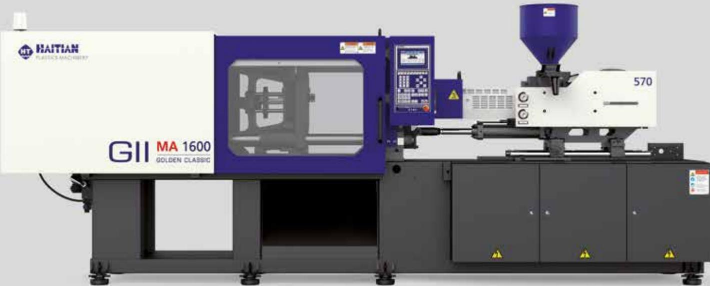
Nueva serie de máquinas **Haitian Mars/GII** de inyección de termoplásticos con servomotor, guías lineales en la inyección y unidad de cierre con bujes autolubricados
