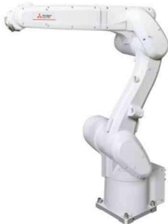
ga útil de 12 kg para cubrir una gran área de trabajo, eliminando la necesidad de una vida vertical de un eje adicional. Las funciones integradas proporcionan una mayor seguridad, una implantación simplificada y una reducción general del tiempo de inactividad.
