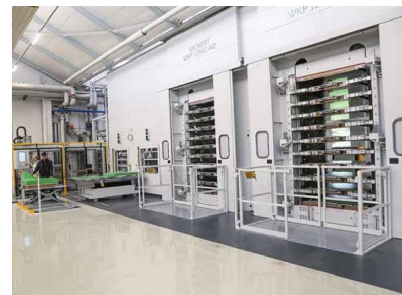
Diseño 3D de un sistema de automatización (arriba) e instalación completa (abajo): WICKERT ofrece soluciones de automatización a medida. Aquí se muestra un sistema completo de automatización de prensas fuera de la sala blanca para la producción de revestimientos de suelos. (Fotos: WICKERT)
