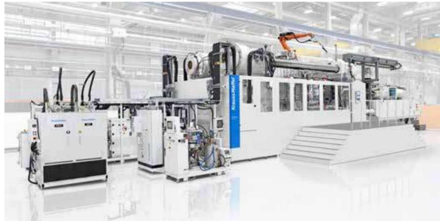
Con ColorForm, las capas de laca de PU se pueden ajustar con precisión en décimas de milímetro. Disponemos de una gama de diferentes efectos y colores de laca que, en combinación con una háptica variable, permiten diversas opciones de diseño.
