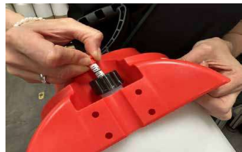
El manómetro de pistón funciona como válvula de seguridad. Se admiten presiones de hasta tres bares. El exceso de presión puede escaparse sin peligro a través del pistón. (Foto: WITTMANN)
