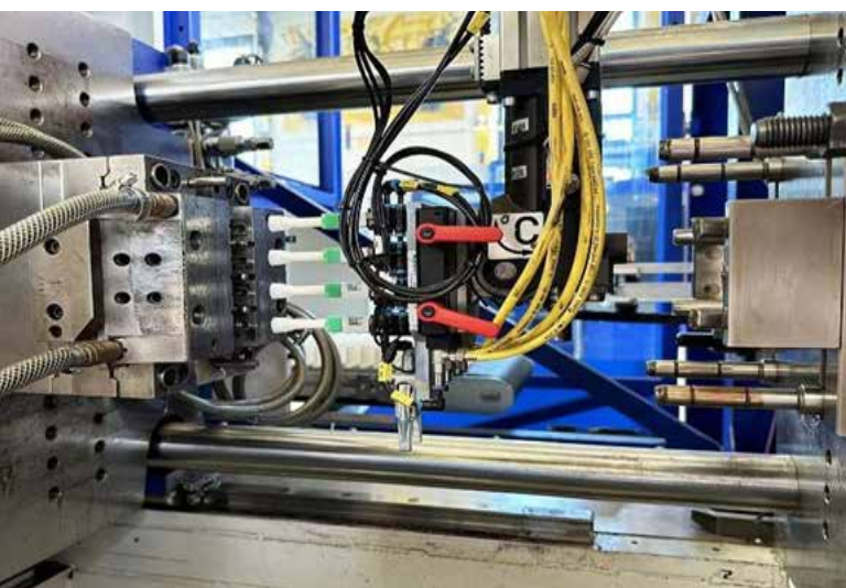
El robot lineal WITTMANN, integrado en el sistema de producción Insider, extrae los pistones del molde de 4 cavidades... (Foto: WITTMANN)
