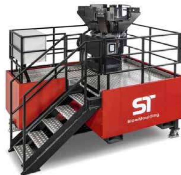
El AHC (cambio automático de cabezal) patentado por ST es el nuevo dispositivo totalmente manos libres patentado
