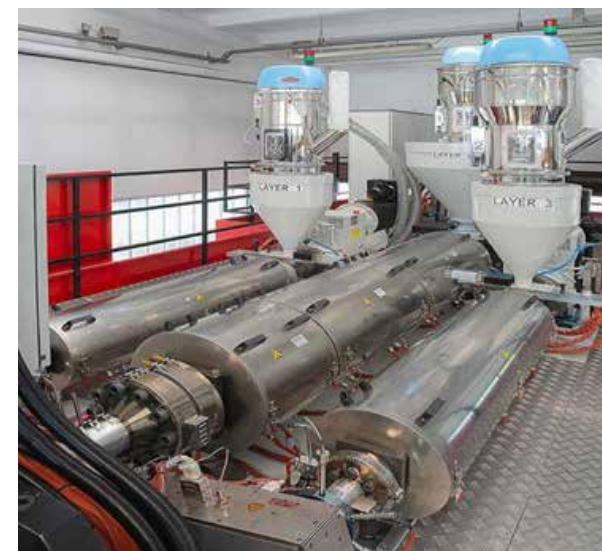
El modelo ECT para la producción de tambores L-Ring de 220 L con cabezal de extrusión continua de 3 capas y PWDS®
