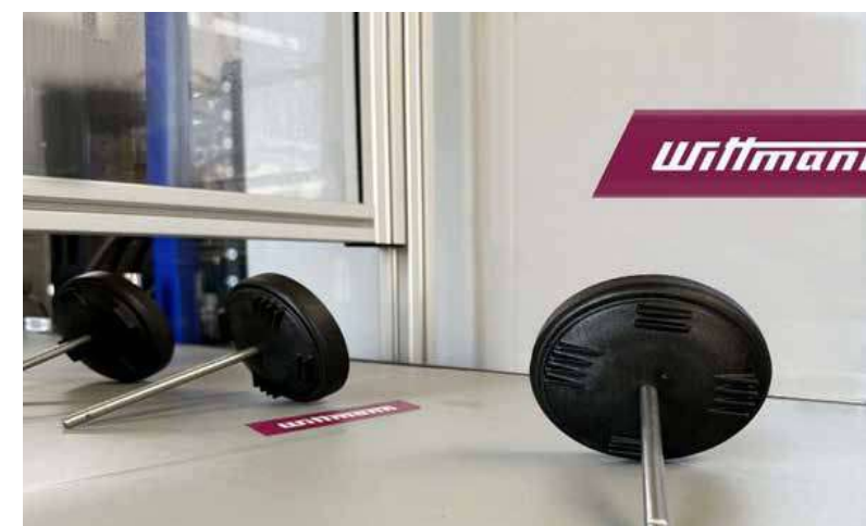
Para producir las tapas de los recipientes a presión, los vástagos de los pistones se sobremoldean directamente. El material procesado es polipropileno reforzado con fibra de vidrio. (Foto: WITTMANN)
