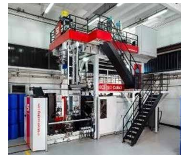
El modelo ECT para la producción de tambores L-Ring de 220 L con cabezal de extrusión continua de 3 capas y PWDS®
