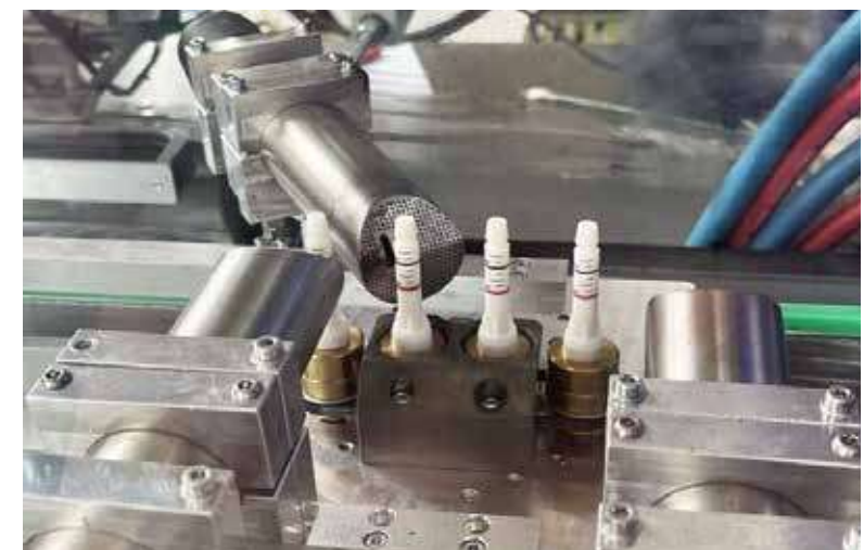
Las tres boquillas de impresión por inyección de tinta colocan un anillo rojo y uno negro, además de una escala, en cada pistón. Para una impresión eficiente de los anillos, los soportes del pistón giran sobre el carro de transporte. (Foto: MESTO)
