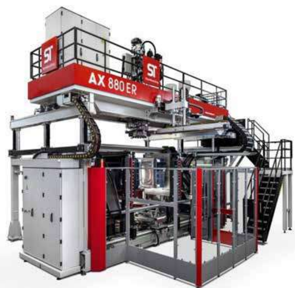
El nuevo modelo AX con unidad de sujeción totalmente eléctrica y plataforma de extrusión desplegable
