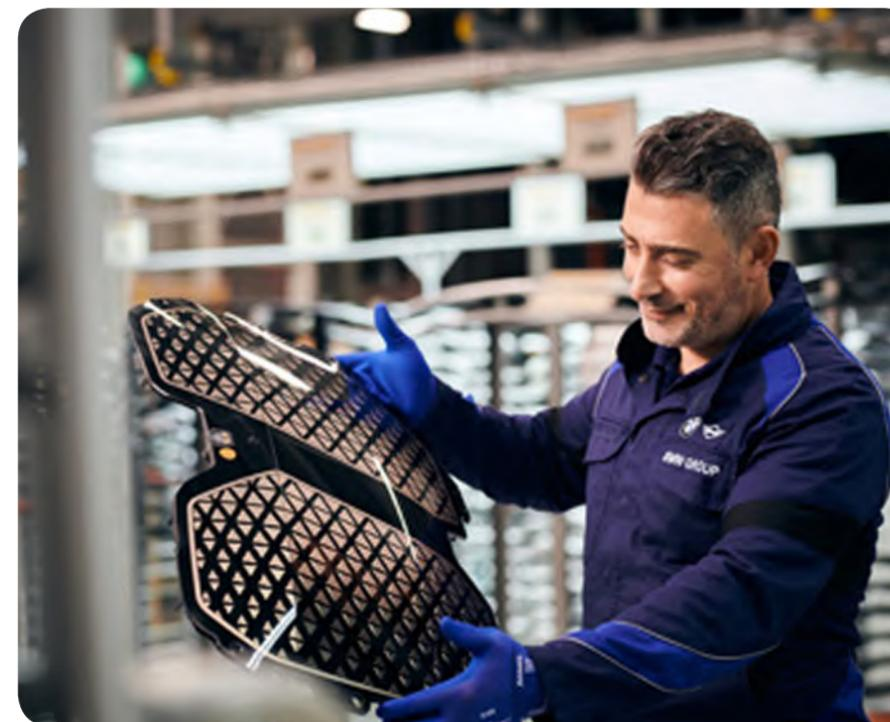
Los distintivos en forma de riñón para el nuevo BMW iX se fabrican en una célula de producción de sala blanca altamente integrada de ENGEL. Se trata de la primera aplicación de producción en serie de la combinación de moldeo por inyección de láminas e inundación de poliuretano en el exigente exterior del vehículo. (Foto: BMW Group)
