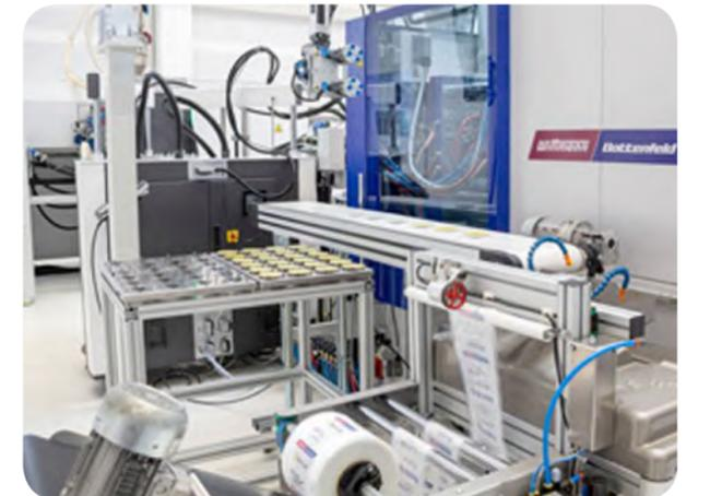
SmartPower 120/350 LSR - estación de depósito y embalaje de piezas
