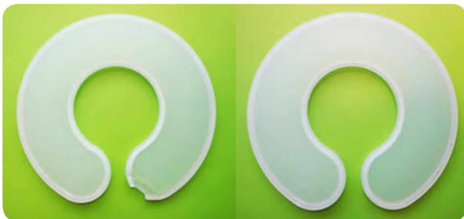
A la izquierda sin, a la derecha con iQ weight control: el software detecta automáticamente las variaciones en la materia prima y las compensa automáticamente en el mismo ciclo.
