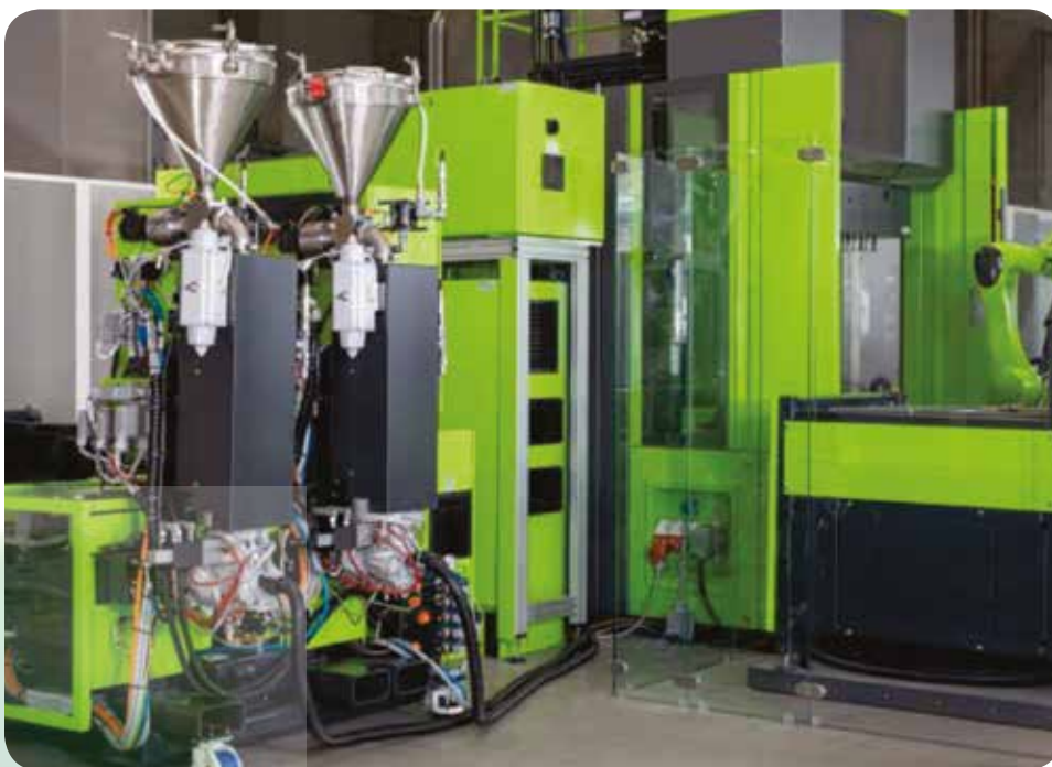
La solución de polimerización in situ de ENGEL para la fabricación de componentes termoplásticos reforzados con fibras destaca por su diseño especialmente compacto. Imagen: ENGEL
