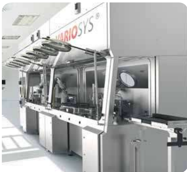
Bausch+Ströbel apuesta por sistemas integrales que permiten un cambio rápido de módulos y ciclos reducidos de esterilización y ampliación. Foto: Bausch+Ströbel
