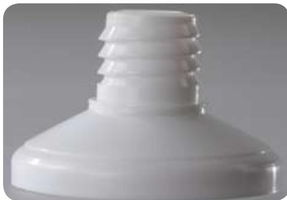
*En la K 2019, ENGEL fabricó cuellos de tubo de HDPE en una máquina de moldeo por inyección e-mac totalmente eléctrica. Imágenes: ENGEL*
