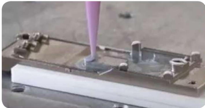
• Dow Inc. dice que su nuevo gel conductor térmico Dowsil TC-3065 para uso en componentes electrónicos admite la dispensación automática.
