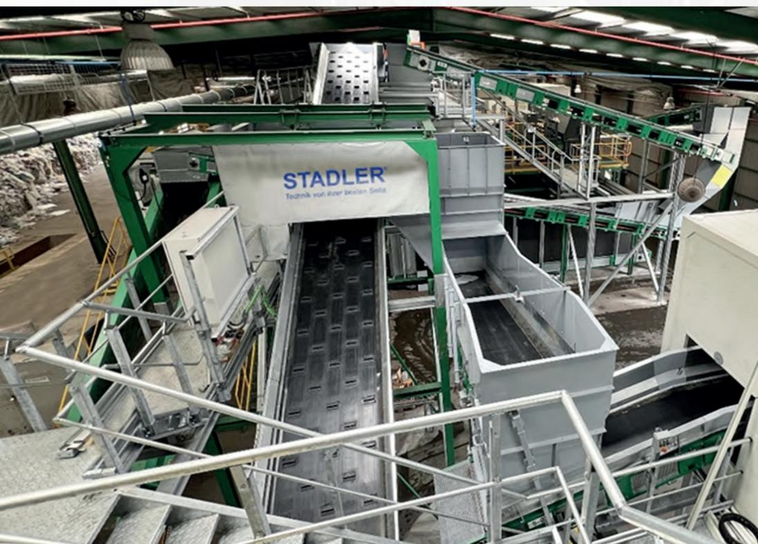
ción y a los separadores balísticos STT2000 con ventilación reforzada.
