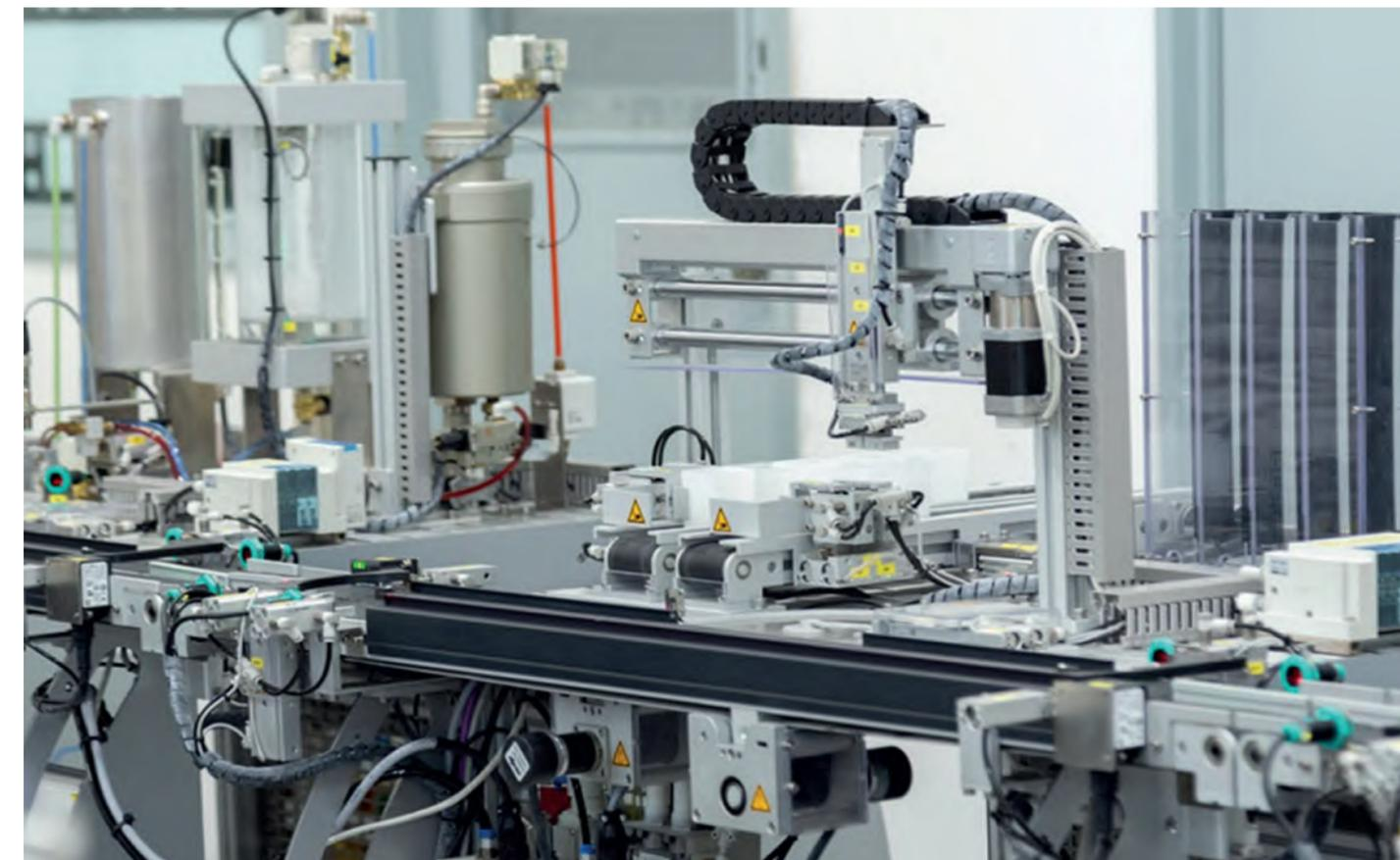
El equipo permite la colocación de pallets con etiquetas de Identificación por Radio Frecuencia (RFID), para controlar de manera remota lo que sucede dentro de cada estación. Posee un programa de detección de fallas que facilita a los usuarios identificar errores y encontrar soluciones.
