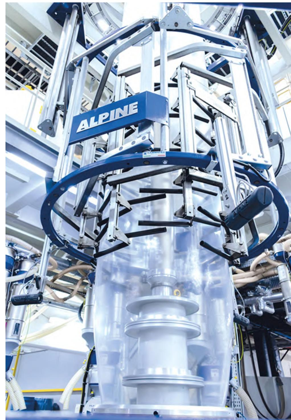
• La MDO en línea es la pieza central de la línea de film soplado de Microplast Coldeplast. El estirado monoaxial del film soplado mejora las propiedades del film y reduce el material de empaque que reduce los costos del film.
