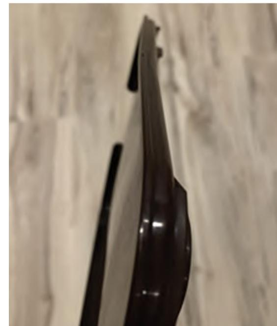
zas que sufren marcas de hundimiento, pero puede causar problemas estéticos adicionales, ya que la espuma choca con la superficie de la pieza. Se puede utilizar el método de moldeo por inyección asistida por gas para mejorar las marcas de hundimiento haciendo que las paredes de la pieza sean más gruesas antes de pasar un canal de gas para extraerlas. Pero esta solución añade peso al producto final y aumenta la cantidad de material utilizado, lo que hace que la producción sea más costosa”.
