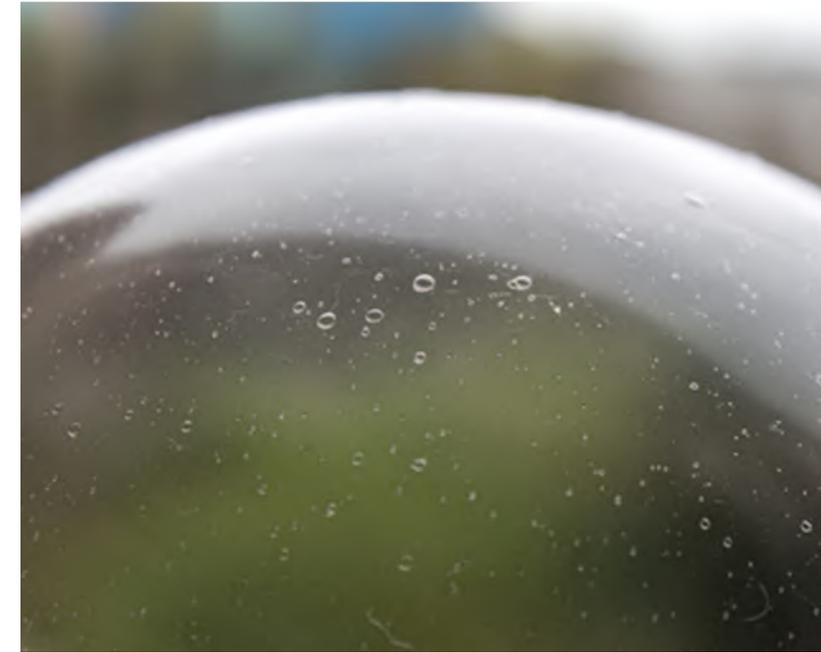
da. Se produce cuando el gas comprimido no logra escapar de la cavidad del molde y, en su lugar, queda contenido dentro del polímero inyectado. Aunque las ampollas pueden producirse cuando el aire queda simplemente atrapado dentro de un molde, son más comunes cuando se trabaja con materiales volátiles.
