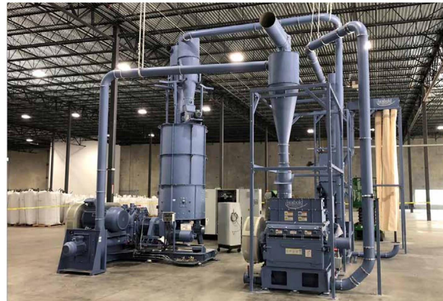
secundario y un clasificador, se puede alcanzar una humedad residual inferior al uno por ciento. Asimismo, se pueden incorporar de forma intensiva diversos aditivos, como lubricantes, plastificantes o pigmentos de color, mediante unidades de dosificación especiales en el tornillo de alimentación. La preparación de compuestos o la recristalización de escamas de PET son otros campos de aplicación.
