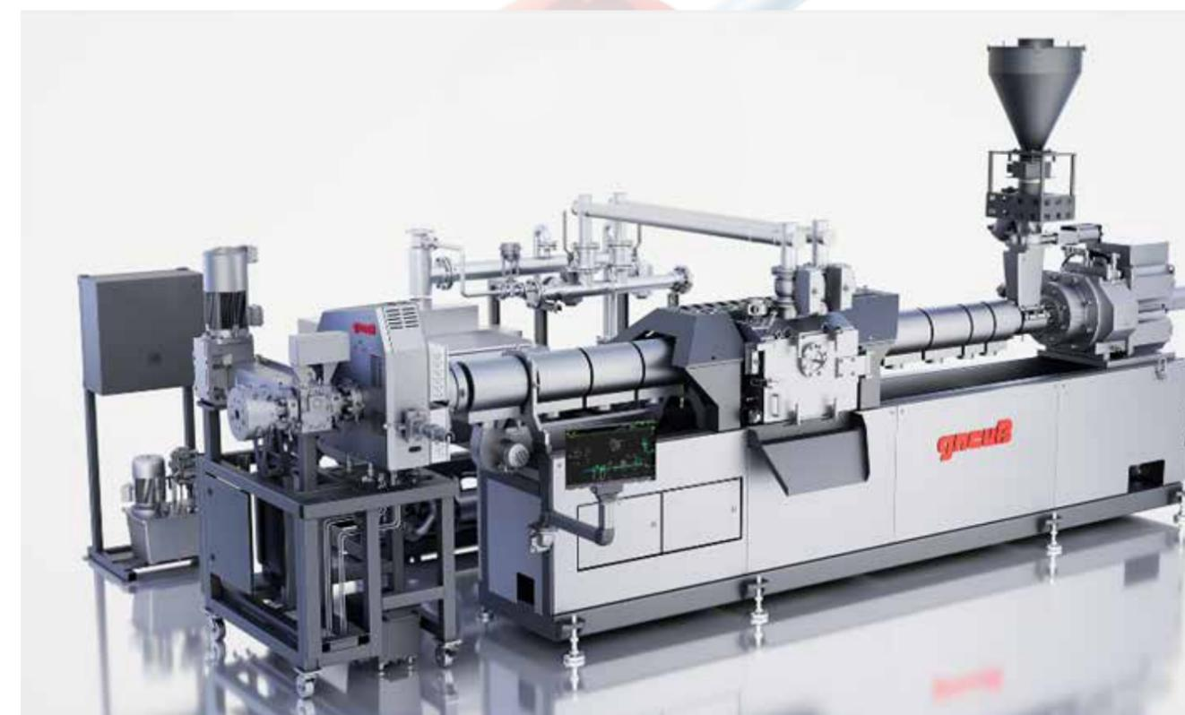
de utilizar en la descontaminación de residuos posconsumo para producir productos en contacto directo con alimentos, como tapas de botellas de HDPE, botellas de leche y taponos de café, y para la reducción de olores y la desgasificación de PA, SAN u otros polímeros.
