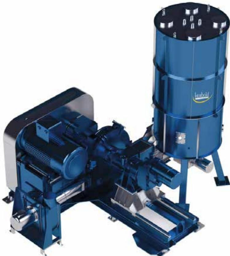
moldeo por inyección. Con los compactadores de plástico de Herbold Meckesheim, incluso los pasos intermedios complejos se pueden ahorrar al reprocesar PET reciclado: el aglomerado no requiere silos especiales para su almacenamiento, ya que se puede descargar y transportar fácilmente, a diferencia de las escamas clásicas. Además, el PET reciclado ya está parcialmente cristalizado mediante la aglomeración.
