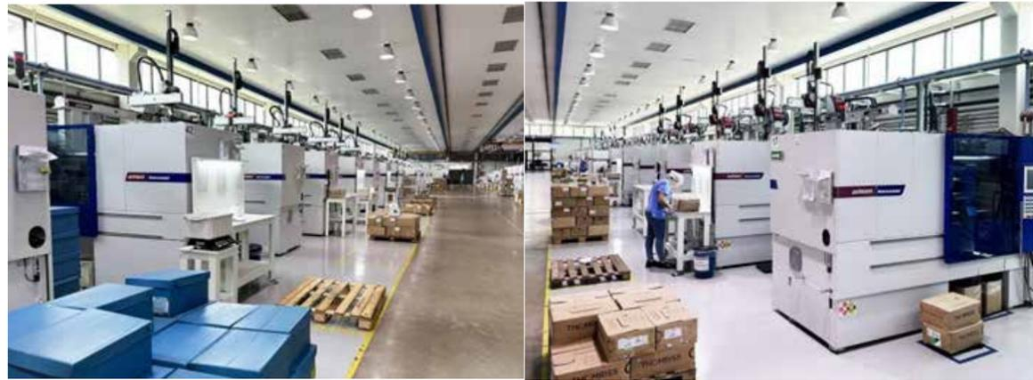
• Un total de 44 máquinas de moldeo por inyección están en funcionamiento. La mayor parte corresponde a las máquinas servohidráulicas SmartPower de WITTMANN, cada una equipada con un robot lineal WITTMANN. (Fotos: WITTMANN)
