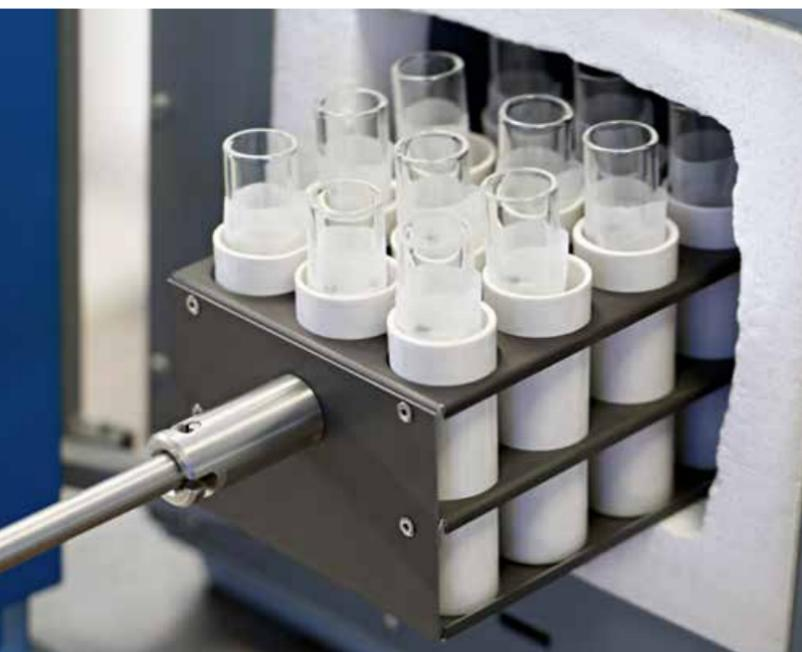
*Conveniente: el módulo de incineración simplifica el procesamiento y la transferencia de muestras*
