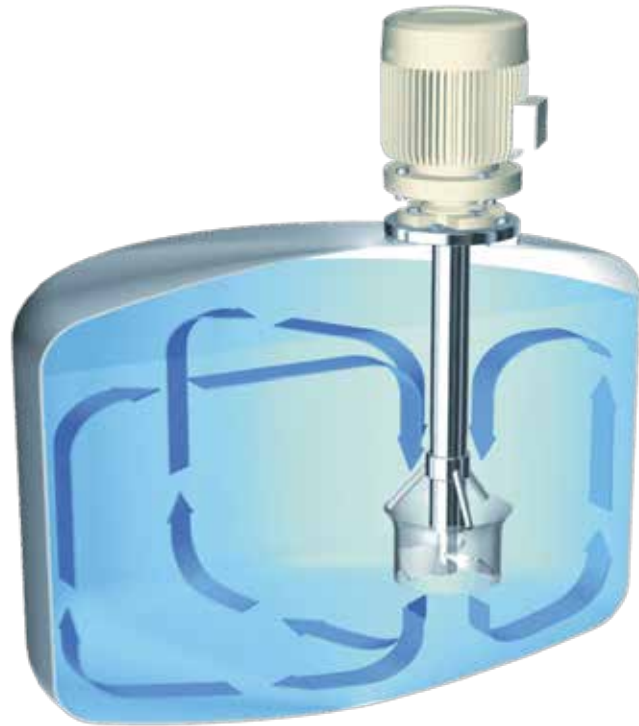
Fig. 3 Los mezcladores YSTRAL Jetstream realizan procesos de mezcla con una zona de micro-mezcla turbulenta en el cabezal de mezcla y una macromezcla casi libre de turbulencias de todo el contenido del recipiente (créditos de las imágenes: ystral).
