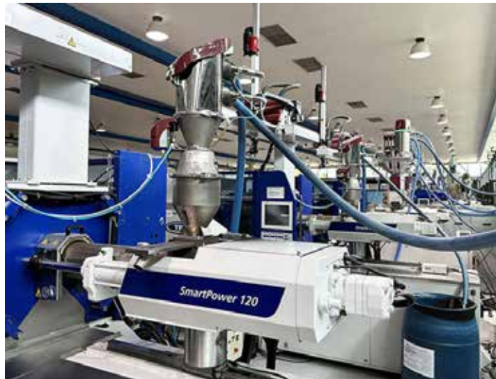
Todo de un solo proveedor: la alimentación de granulado es gestionada exclusivamente por auxiliares de WITTMANN. (Foto: WITTMANN)
