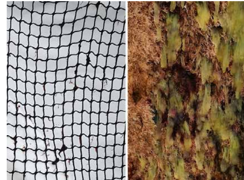
Fig.1 Bioincrustación después de 140 días en una red de acuicultura sin recubrimiento (derecha) y una red de acuicultura con recubrimiento sin cobre de Steen-Hansen (izquierda) (créditos de las imágenes: Steen-Hansen)
