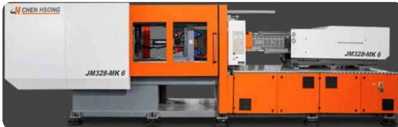
Máquina Chen Hsong JM328-MK6 con unidad 2K. Máquina bimaterial
