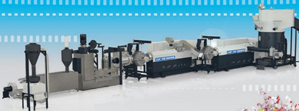
La tecnología TANDEM aplicada al reciclaje de materiales plásticos altamente impresos, contaminados y con mucha humedad garantiza la excelente calidad de la granza con un notable ahorro energético en comparación con los sistemas de reciclaje convencionales que prevén la re-extrusión del material.
