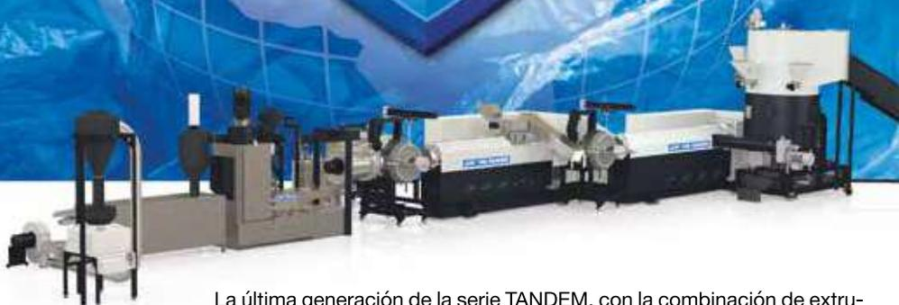
La última generación de la serie TANDEM, con la combinación de extrusoras mono-husillo y doble-husillo y un sistema de degasificación más eficiente, da valor agregado a los materiales reciclados en relación al respeto del ambiente.
