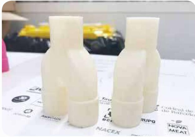
Adaptador válvula, parte de respirador. (Foto: ELIX Polymers, PR058)
