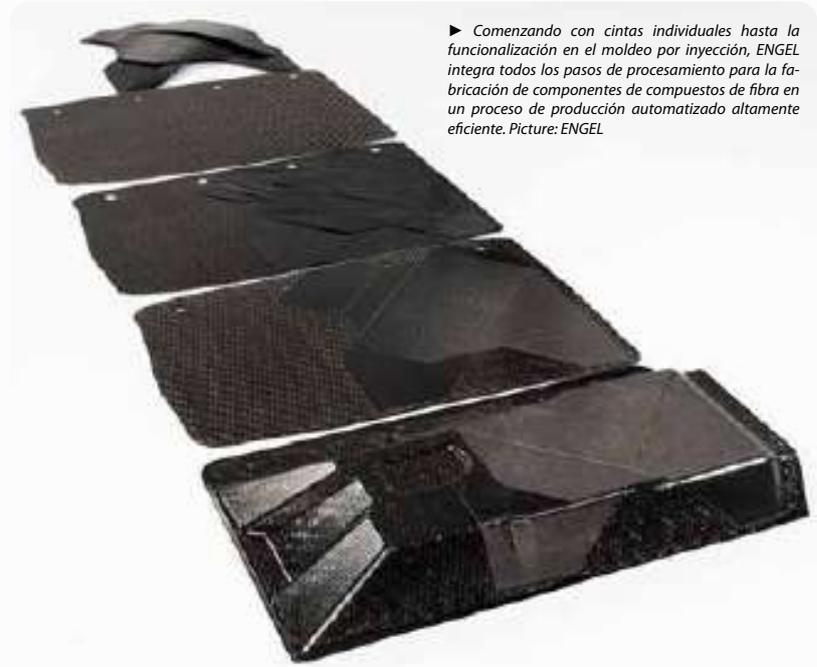
► Comenzando con cintas individuales hasta la funcionalización en el moldeo por inyección, ENGEL integra todos los pasos de procesamiento para la fabricación de componentes de compuestos de fibra en un proceso de producción automatizado altamente eficiente. Picture: ENGEL
