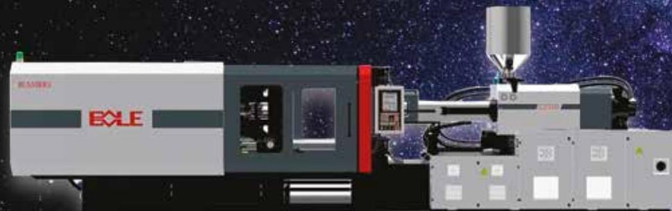
Presentación de las nuevas series de inyectoras año 2020, todas con sistema de cierre de rodillera central patentado y servo bombas para ahorro energético
