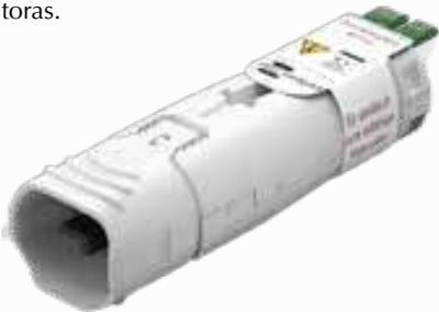
Este módulo está diseñado para el tratamiento superficial de sustratos no conductores como plásticos, cerámicas o vidrio. Para un tratamiento efectivo, se recomienda una distancia de módulo a sustrato de 1 a 5 mm. Si se produce un arco eléctrico incontrolado en el sustrato durante el uso, el dispositivo se apaga automáticamente. En este caso, la superficie es al menos parcialmente conductora y, por lo tanto, debe tratarse con el módulo Nearfield.
