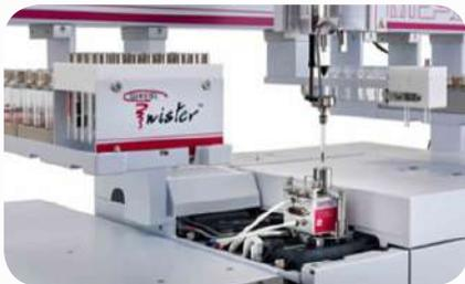
Se utilizó un sistema de GC / MS similar para analizar bisfenoles en agua.
