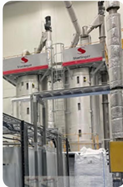
SSP reactors: Tratamiento de vacío en los reactores SSP viscoSTAR para aumentar la IV y descontaminación haciendo que el PET reciclado sea seguro para embalajes en contacto con alimentos. ©CPA
