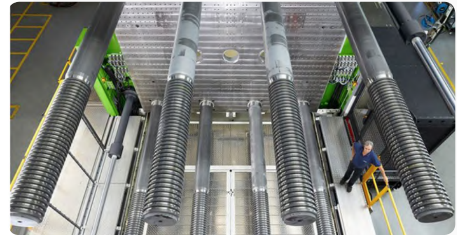
• El gran espacio para la instalación de moldes -que aquí se muestra en una máquina de moldeo por inyección con una fuerza de cierre de 8.000 toneladas- abre nuevas oportunidades para piezas muy grandes, por un lado, y procesos altamente integrados, por otro. (Fotos: ENGEL)
