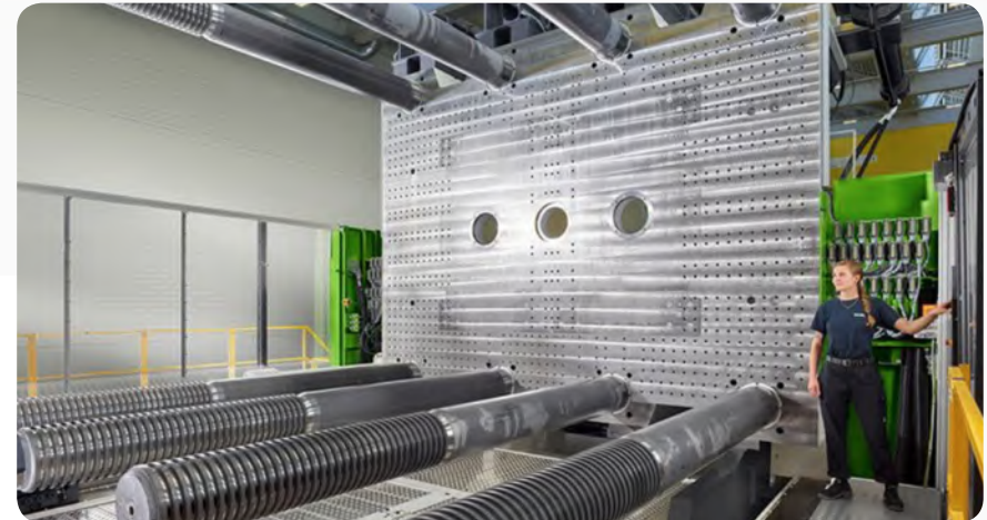
• El gran espacio para la instalación de moldes -que aquí se muestra en una máquina de moldeo por inyección con una fuerza de cierre de 8.000 toneladas- abre nuevas oportunidades para piezas muy grandes, por un lado, y procesos altamente integrados, por otro. (Fotos: ENGEL)
