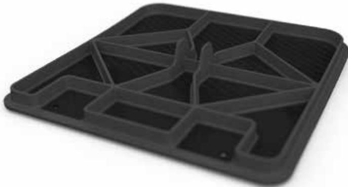
• La alternativa termoplástica sostenible y rentable a la solución termoendurecible anterior con piezas de aluminio fresado atornilladas: ENGEL produce compuertas de inspección para aviones de pasajeros con el proceso ENGEL organomelt. (Foto: ENGEL)
