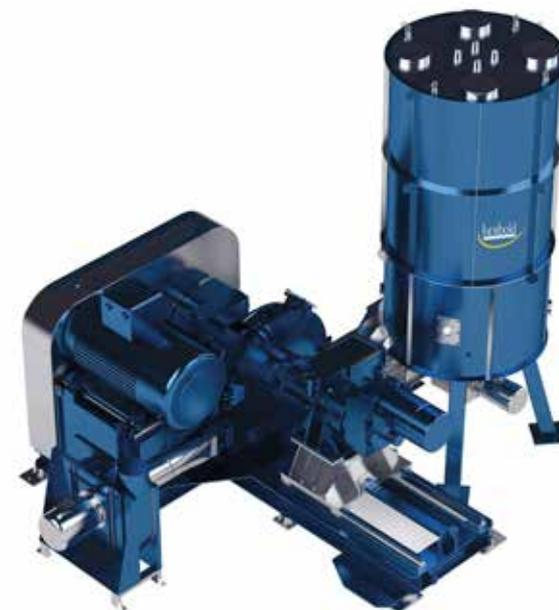
El compactador de plástico HV 70 es el más potente de la serie de Herbold Meckesheim. Comprime la materia prima en funcionamiento continuo entre un disco giratorio y uno estacionario, equipados con barras de amasado atornillables y fácilmente reemplazables.
