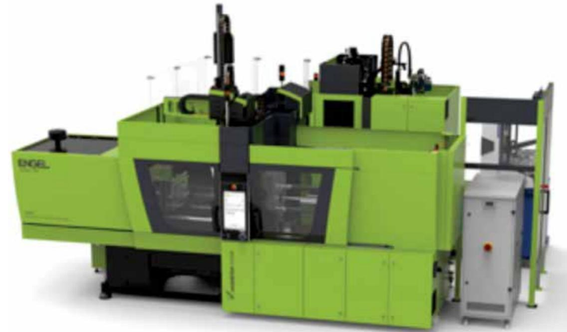
combinará una victory 120 AMM con una máquina de moldeo por inyección vertical ENGEL insert 60V/45 equipada con una placa giratoria de dos estaciones para fabricar piezas de recipientes de demostración bicomponente.
