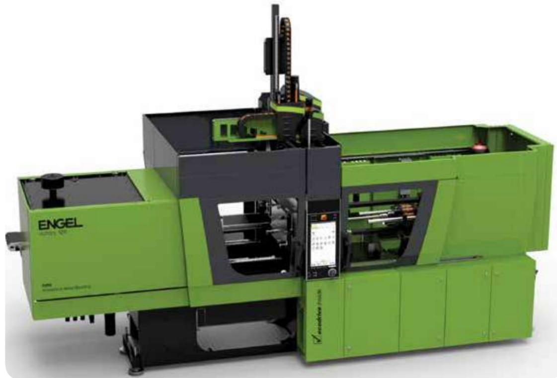
Para el procesamiento de materiales amorfos de la serie Amloy de Heraeus, ENGEL ha desarrollado una nueva máquina de moldeo por inyección basándose en victory, su acreditada serie de máquinas hidráulicas sin columnas.
