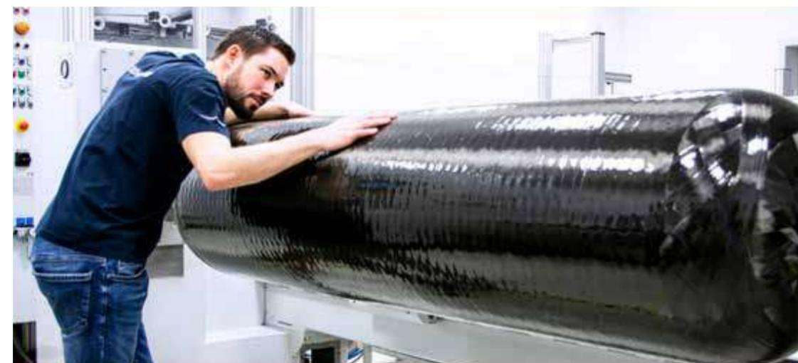
320 litros para hidrógeno. Los expertos en soplado de Kautex Maschinenbau han conseguido fabricar un cilindro revestido de poliamida de gran tamaño para recipientes de presión de hidrógeno con el proceso de extrusión por soplado.
