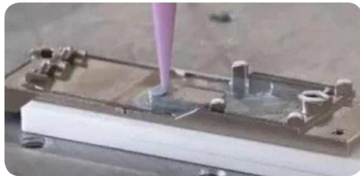
●Dow Inc. dice que su nuevo gel conductor térmico Dowsil TC-3065 para uso en componentes electrónicos admite la dispensación automática.
