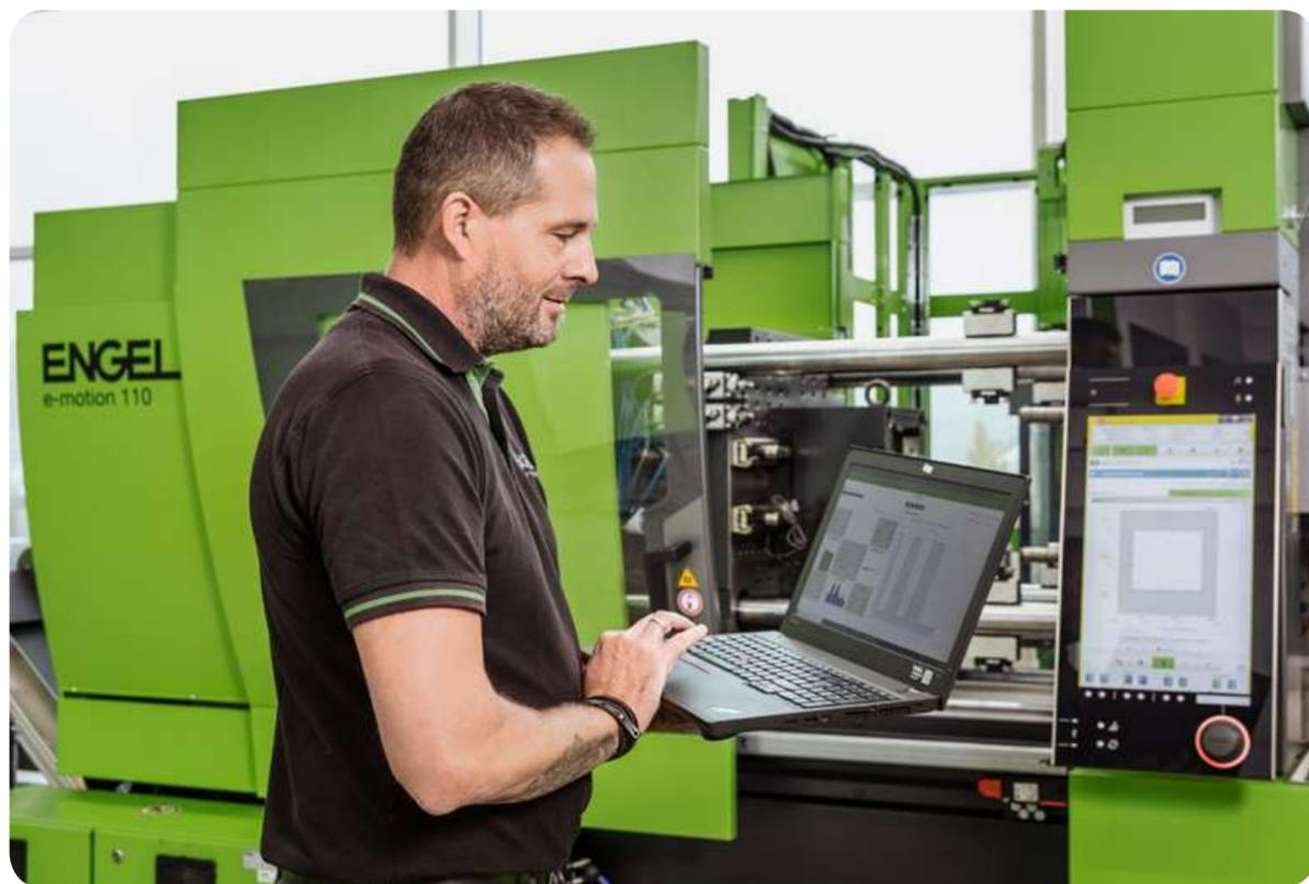
Gracias a sim link, los datos de la simulación pueden transferirse directamente a la máquina de moldeo por inyección y, a la inversa, los registros de datos de medición pueden importarse de la unidad de control de la máquina al programa de simulación. Los productos de servicio digital aumentan la disponibilidad de las máquinas y unidades de producción, garantizando una alta productividad y una capacidad de entrega continua incluso en caso de crisis. Imágenes: ENGEL.
