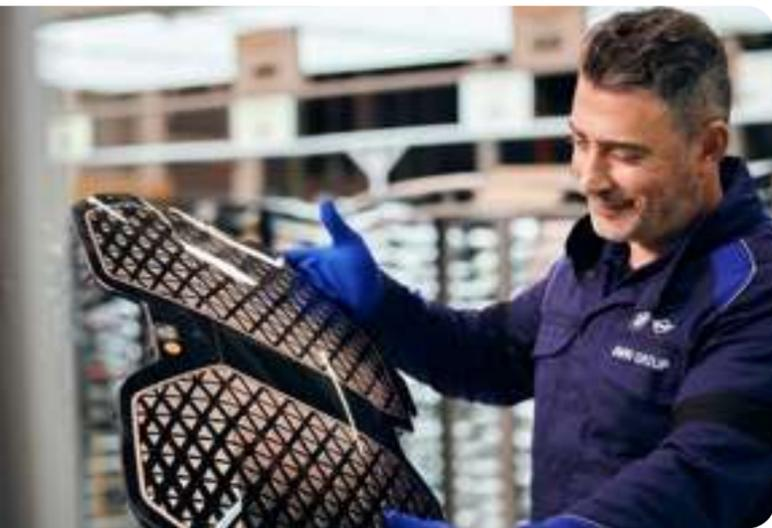
Los distintivos en forma de riñón para el nuevo BMW iX se fabrican en una célula de producción de sala blanca altamente integrada de ENGEL. Se trata de la primera aplicación de producción en serie de la combinación de moldeo por inyección de láminas e inundación de poliuretano en el exigente exterior del vehículo. (Foto: BMW Group)
